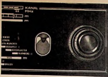
Bild 5. Die EM 85 hinter einer Skala eingebaut
