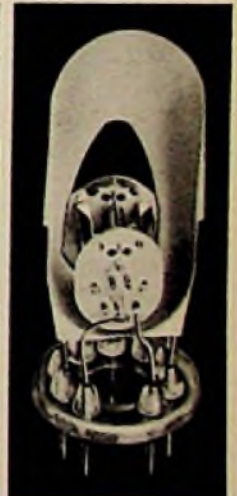
Bild 3. System-Aufbau der EM 85 nach Abnahme der Triodenkappe
