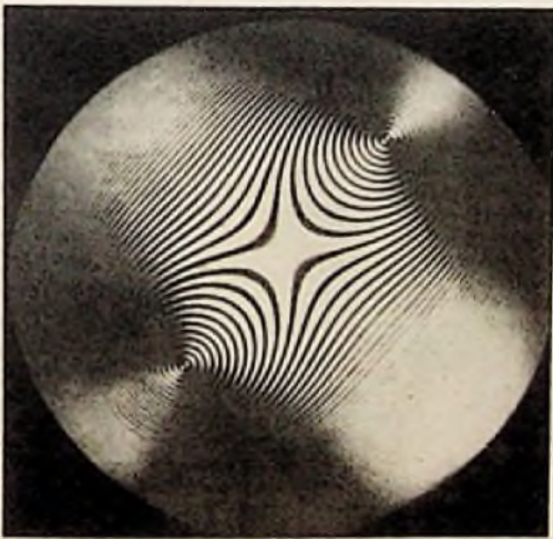
Konoskop-Aufnahme eines bei der ELAC gezüchteten Seignette-Salz-Kristalles
