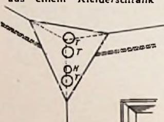
Bild 5. Deckenecklautsprecher mit einem Hoch- und drei Tieftonsystemen
