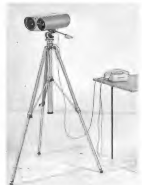
Bild 1. Das Lichtsprechgerät LIG 3 auf einem Fotostativ montiert. Rechts das Fernbedienungskästchen mit dem Handapparat
