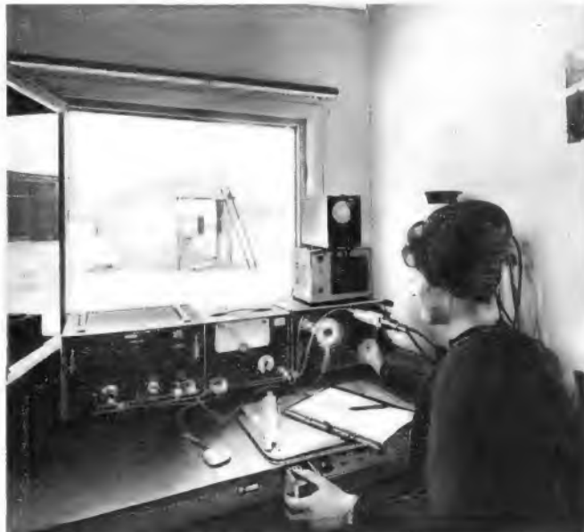
Bild 2. Störstrahlungsmessung im Philips-Fernsehgerätewerk Krefeld. Blick aus dem Meßhaus auf das Objekt, es wird gerade die UHF-Abstrahlung von Bereich III gemessen. Auf dem Arbeitsplatz sind folgende Geräte zu erkennen (von links nach rechts): Fernsehfrequenz-Panoramaempfänger P 55 S 1 von Plisch, Meßsender P 60 M/300–1000 MHz (Plisch), UHF-Konverter 470–860 MHz auf Kanal 2 des Panoramaempfängers umsetzend (Selbstbau), Hf-Umschalter HA 82/2 zum Vergleich Störspannung-Sender (Rohde & Schwarz). Darüber steht eine Wechselsprechanlage und darauf das Sichtgerät für den Panoramaempfänger. An der Tischkante vorn ist das Steuerpult für Meßtisch und Antennenbewegung angebracht
