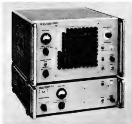
Bild 8. Das Hewlett-Packard-Frequenz-normal 5100 A läßt sich in Schritten von 0,01 Hz auf alle Frequenzen bis zu 50 MHz mit Hilfe von Drucktasten einstellen
