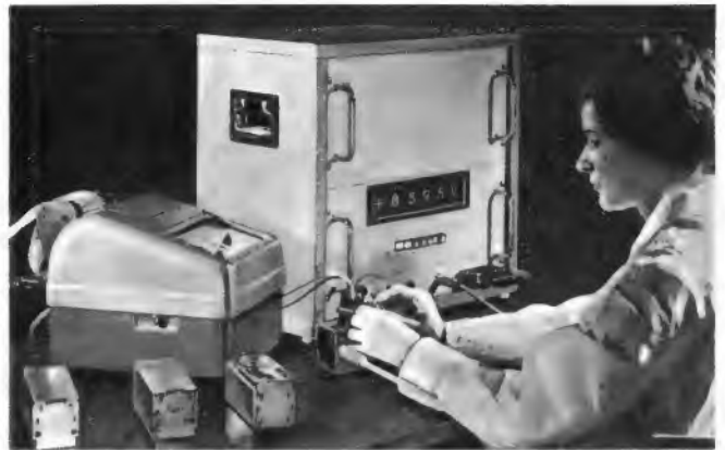
Links: Bild 6. Effektivwertvolumeter 3400 A von Hewlett-Packard
