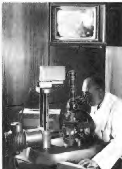
Eine Fernsehkamera überträgt das mikroskopische Bild auf mehrere im Hörsaal verteilte Sichtgeräte
