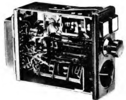
Steckbarer Regieeinsatz mit Gruppenschalter, Halleinsteller und Leuchttasten (Telefunken)
