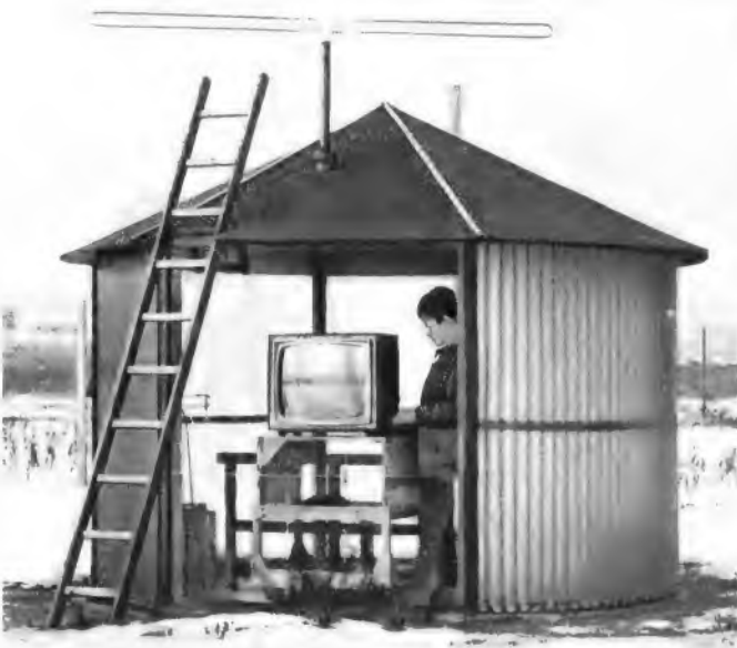
Bild 1. Der zu messende Fernsehempfänger in der Witterungsschutzhütte aus Kunststoff; auf dem Dach der Meßdipol
