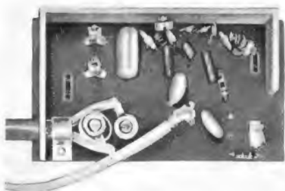
Bild 5. Antennenbuchsen mit VHF-Symmetrieträger und VHF-Bandpaß. Die Verbindung zum Kanalwähler erfolgt über ein 60-Ω-Kabel mit Abschirmung
