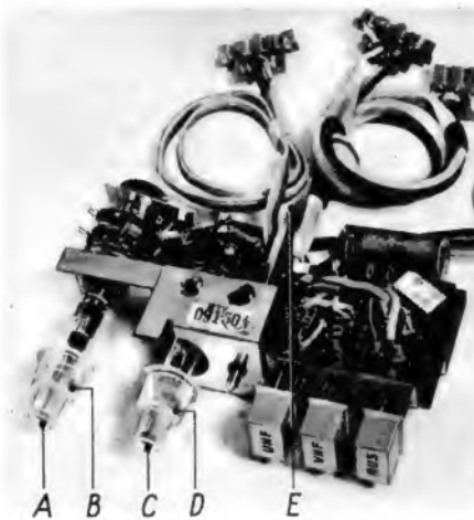
Bild 5. Bedienungseinheit für das Gerät FE 314; A = Helligkeit, B = Kontrast, C = Lautstärke, D = Tonblende, E = Befestigungsschraube; oben am Bildrand die Steckverbindungen
