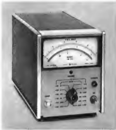
Links: Bild 6. Effektivwertvolumeter 3400 A von Hewlett-Packard
