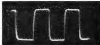
Bild 30. Rechteckfrequenz 1000 Hz, geschickt durch einen Tiefpaß mit der oberen Grenzfrequenz  $f_{go} = 10 \text{ kHz}$
