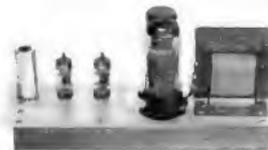
**MODULATOR MV 58** für den Sender SB 50 K zur Anodenschirmgitter-Modulation, auf dem gleichen Chassis wie der Sender aufgebaut, Rf.: 3 x EC 92, 2 x EL 34 **98.-**
