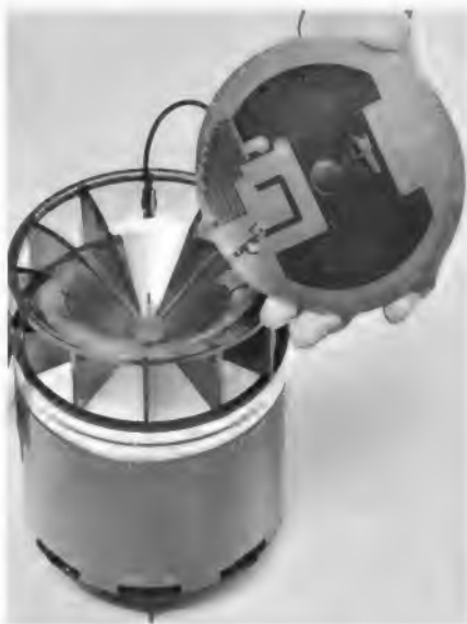
„Rondelle“ nennt Zenith diesen transistorbestückten AM/FM-Empfänger mit „360°-Rundum-Klang“ und geätzter UKW-Antenne
