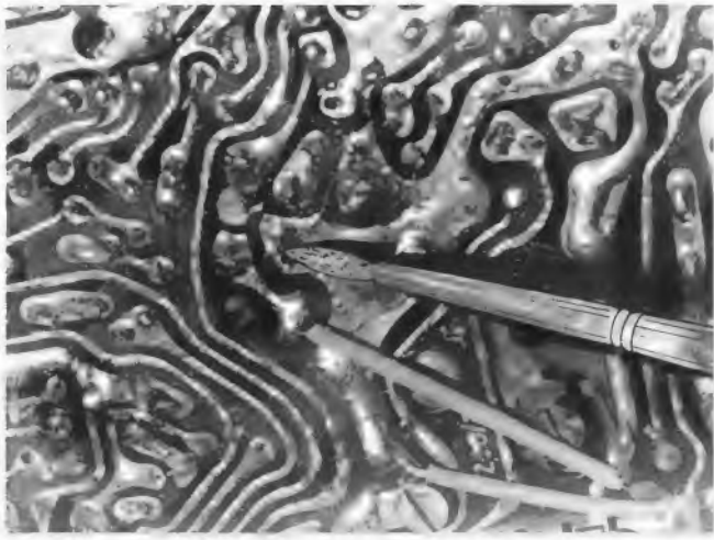
Bild 7. Mit dem Pinsel lassen sich an Leiterplatten, Bauteilen und Schaltungen leicht Korrekturen und leitende Verbindungen herstellen
