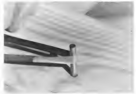
Bild 5. Die Haftfestigkeit und Elastizität des getrockneten Leitlackaufstrichs wird bei einer Folie (Tonband) geprüft, indem man sie mehrfach mit etwa 180 Grad um einen Metallstift zieht. Drückt man gleichzeitig ein Tuch gegen die gekrümmte Leitlackeschicht, ergeben sich Aufschlüsse über die Abriebfestigkeit. Ein weiterer Hafttest besteht darin, ein Tesaband auf die Leitschicht zu kleben und dann abzuziehen. Die Schicht soll möglichst auf der Unterlage haften bleiben
