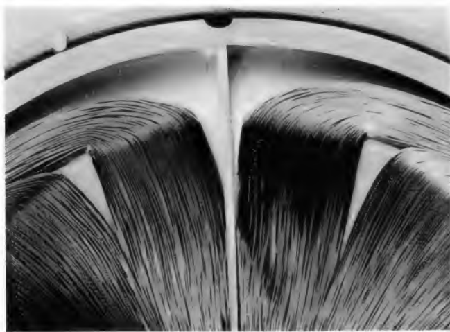
Bild 3. Teilansicht einer stranggewickelten Sattelspule. Die Unterteilung des Wickelpaketes in Unterabschnitte ist deutlich zu erkennen
