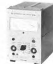
6 NF-Millivoltmeter UVN. 10 Hz...1 MHz; 0,1 mV...300 V Störspannungsdämpfung 120 dB. Erdfreie Schaltung mit hochohmigem Eingang. Hohe Stabilität durch starke Gegenkopplung.
