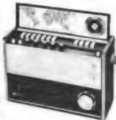
f. Netz u. Batt., Gerät m. hervorragender Leistung und enormer Klangfülle. Geeichte Breitbandskala, Weltkarte m. Weltzeit-Indikator, Feldstärke-Indikator, KW-Lupe, BFO, AFC und Rauschsperr.
