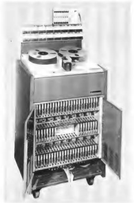
Bild 1. 16-Kanal-Tonmaschine Mincom 2“ der 3-M-Company
