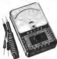
20 000 Ω/V =, 4000 Ω/V Wechselspannung/Spiegel-
