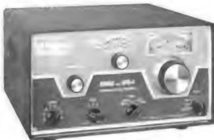
Mit diesem Empfänger hat Drake ein Gerät auf den Markt gebracht, das durch seinen ausgedehnten Frequenzbereich, verbunden mit ausgezeichneten Empfangseigenschaften durch Verwendung von DUAL-GATE FET's und der Möglichkeit von Netz- und Batteriebetrieb, sehr vielseitig einzusetzen ist.
