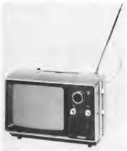
Bild 3. Philips nennt dieses Portable Fernseh-Philitina, ausgestattet mit 23-cm-Bildröhre und Schieberegler an der rechten Seite. Stations-tasten fehlen
