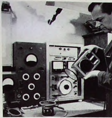
Bild 3. Untersuchung von Tummelbewegungen einer Membran mit dem Stroboskop
