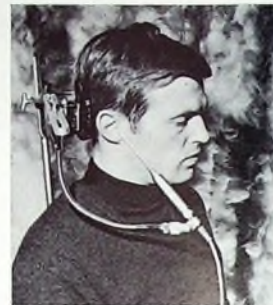
Anordnung zur Messung des Schalldrucks am äußeren Eingang des Gehörgangs mit Hilfe eines Kondensator-Sonden- ◀ mikrofon
