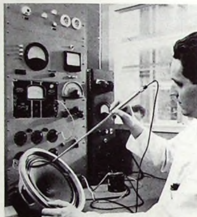
Bild 4. Untersuchung von Teilschwingungen des Membran mit einem Sondenmikrofon
