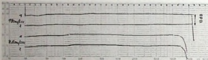
Bild 12. Frequenzgänge des „TG 550“
