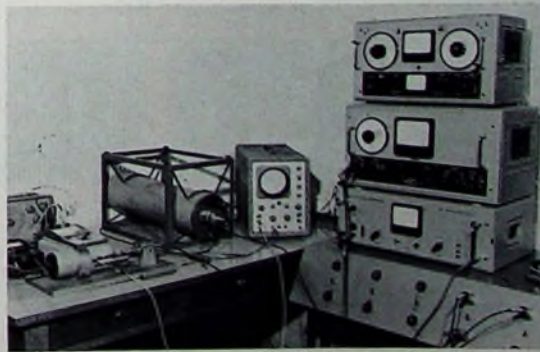
Analogrechner für die Simulation von Mikrofonen und Kopfhörern im 'AKG-Laboratorium' Wien
