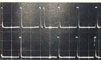
Bild 6. Signal nach Begrenzung und Siebung am Ausgang B (1 Hz)
