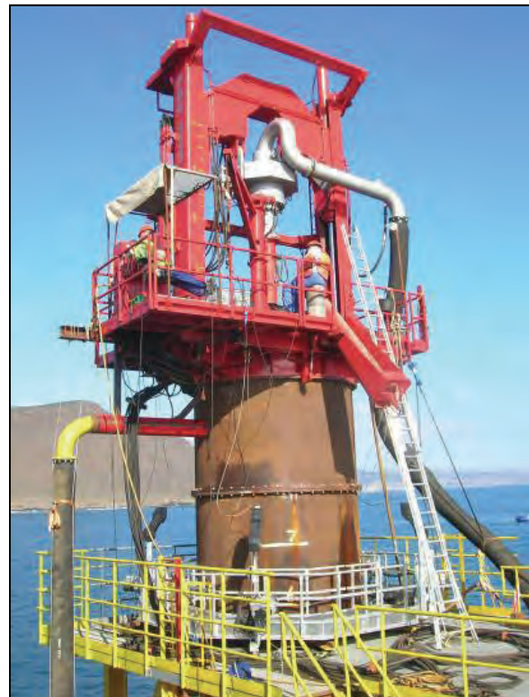
Figur 7 Exempel på ett rotationsbord Källa: Saipim s.a.
