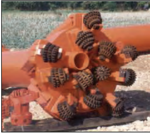
Figur 8 Exempel på borrkrona med bergborrstift Källa: Saipim s.a.
