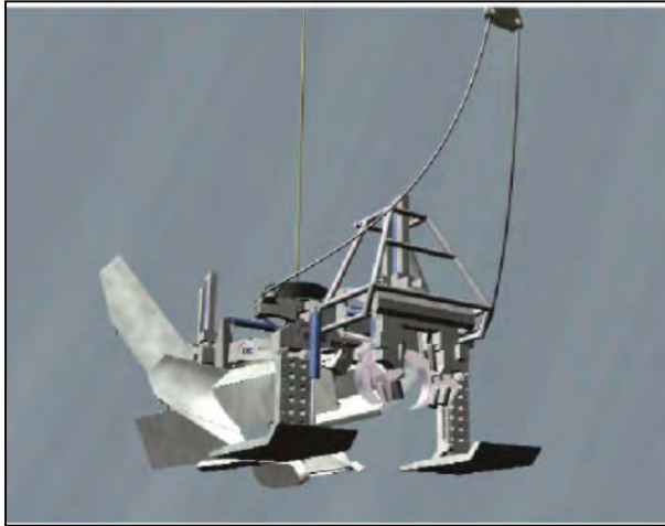
Figur 17 Plog för kabelnedläggning Källa Oceanteam
