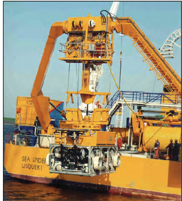
Figur 19 Vattenjet för kabelnedläggning Källa Oceanteam
