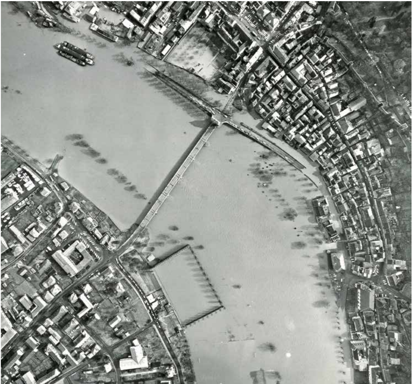
Das Luftbild vom Februar 1970 stellt die Ausmaße eines etwa 20-jährlichen Ereignisses dar. Der Bildausschnitt zeigt, dass die komplett überflutete Mainstraße nur mittels eines Steges überquert werden konnte, um zur Mainbrücke zu gelangen.
