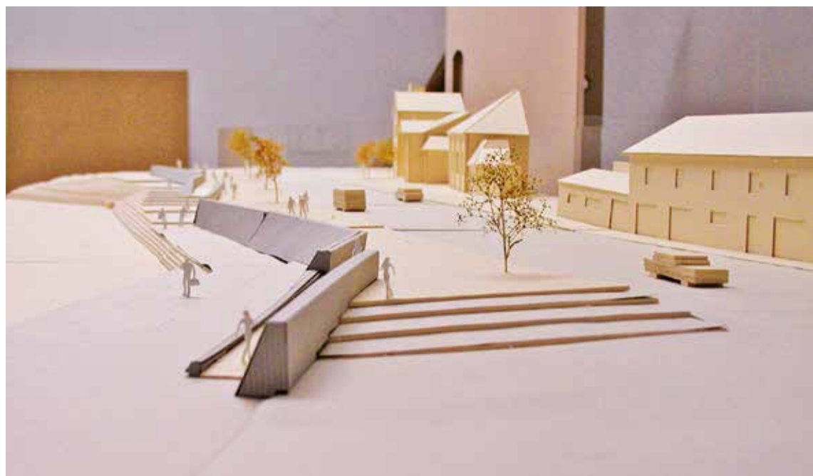
Zur maßstäblichen Darstellung des Entwurfes entstand ein Architekturmodell. Wichtig war dabei nicht unbedingt eine hohe Detailtreue. Das Augenmerk lag auf der Darstellung der zentralen Idee einer Untergliederung der Freiflächen in eine obere Promenade und die tiefer liegenden Aufenthaltsbereiche am Mainufer.
