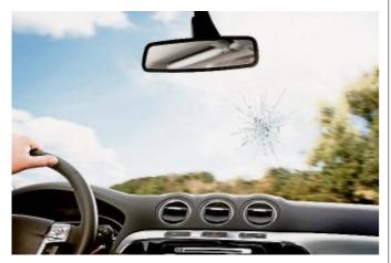
Steinschläge wie dieser dürfen repariert werden. Schäden im Fernsichtfeld jedoch, einem knapp 30 Zentimeter breiten Streifen auf der Fahrerseite, dürfen nicht ausgebessert werden. Hier muss die Scheibe ausgetauscht werden.
