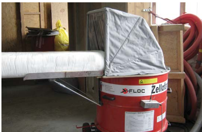
Glasfaser-Materialtest im X-Floc Labor
