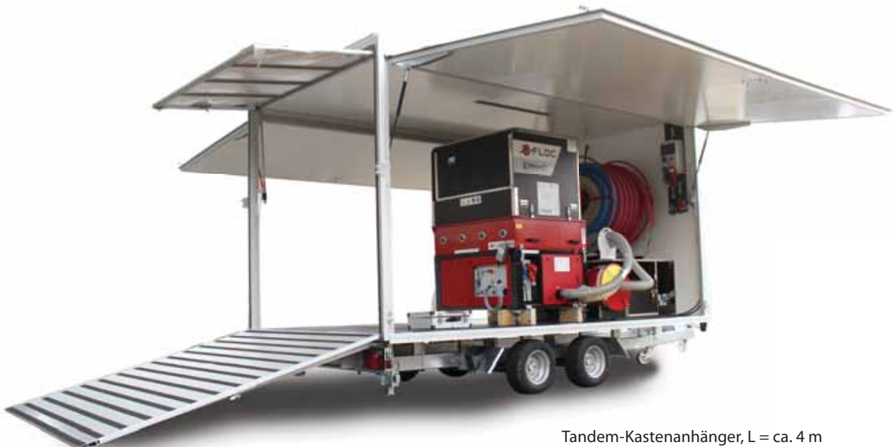
Tandem-Kastenanhänger, L = ca. 3m mit Auffahrklappe und Drehstangenverriegelung
