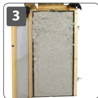
3 Öffnen des Prüfelement und begutachten des Befüllergebnisses
