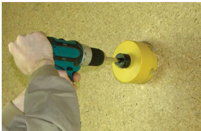
Lochsäge mit Auswurfsystem für Einblasöffnungen in einer Vielzahl Materialien
