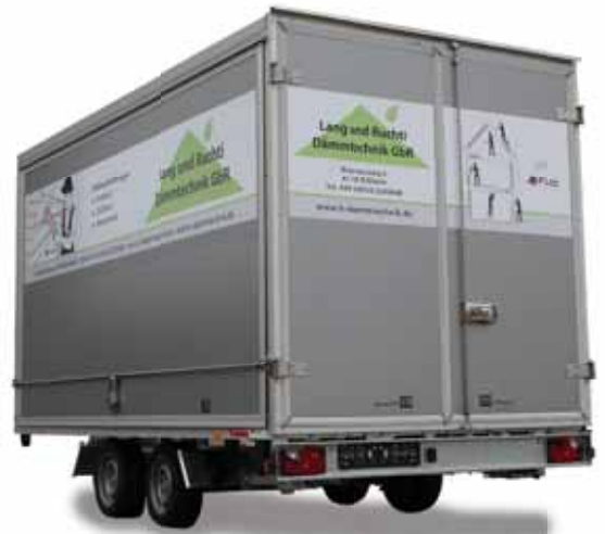
Tandem-Kastenanhänger, L = ca. 4 m mit 2-flügeliger Hecktür und Drehstangenverriegelung
