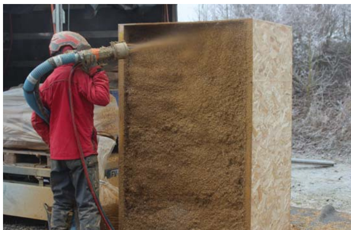
Funktionstest von Dämmmaterial und Einblasmachine
