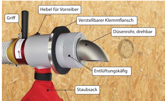
J-Jet mit verstellbarem Klemmflansch
