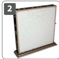
Öffnen des Prüfelement und begutachten des Befüllergebnisses
