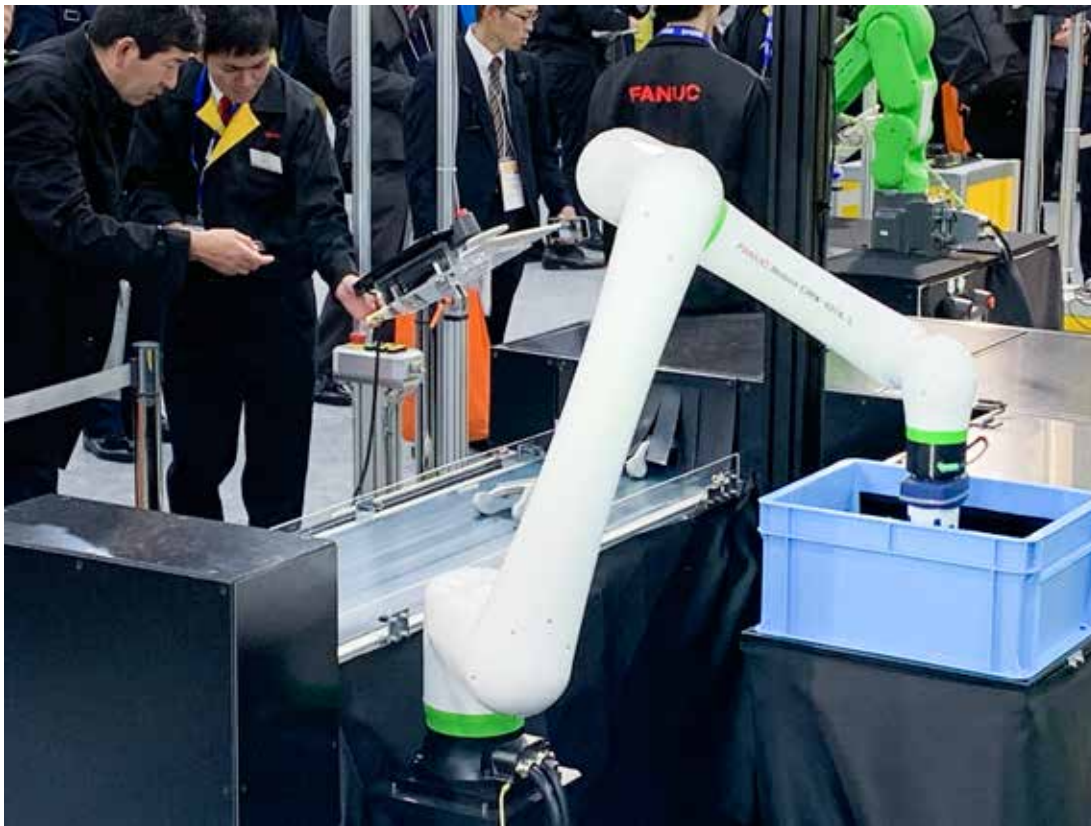
Eine der vielen möglichen Anwendungsszenarien, die der neue Leichtbau-Cobot CRX-10iA spielend bewältigt: Eine Pick-and-place-Aufgabe, wobei der Cobot auch noch mittels seines 3D-Vision-Sensors unterschiedliche Teile erkennt.
