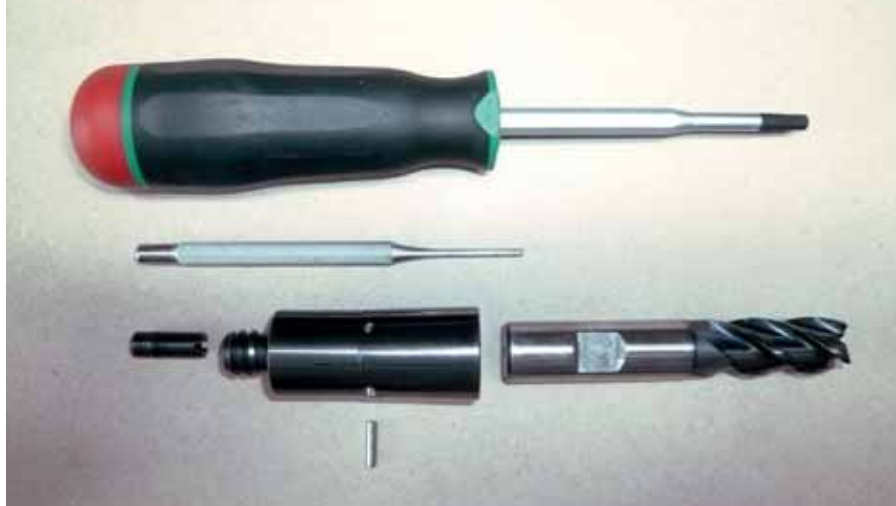
Aufbau der APC-Spannhülse mit Auszugssicherung (untere Reihe von links): Längenschlüssel, Spannhülse mit radialer Bohrung und darunterliegendem Sicherungsstift, Schafffräser mit Weldon-Spannfläche. Darüber: Splinttreiber zur Demontage des Sicherungsstiftes und Drehmomentschlüssel zum Einschrauben des Längenschlüssels.
