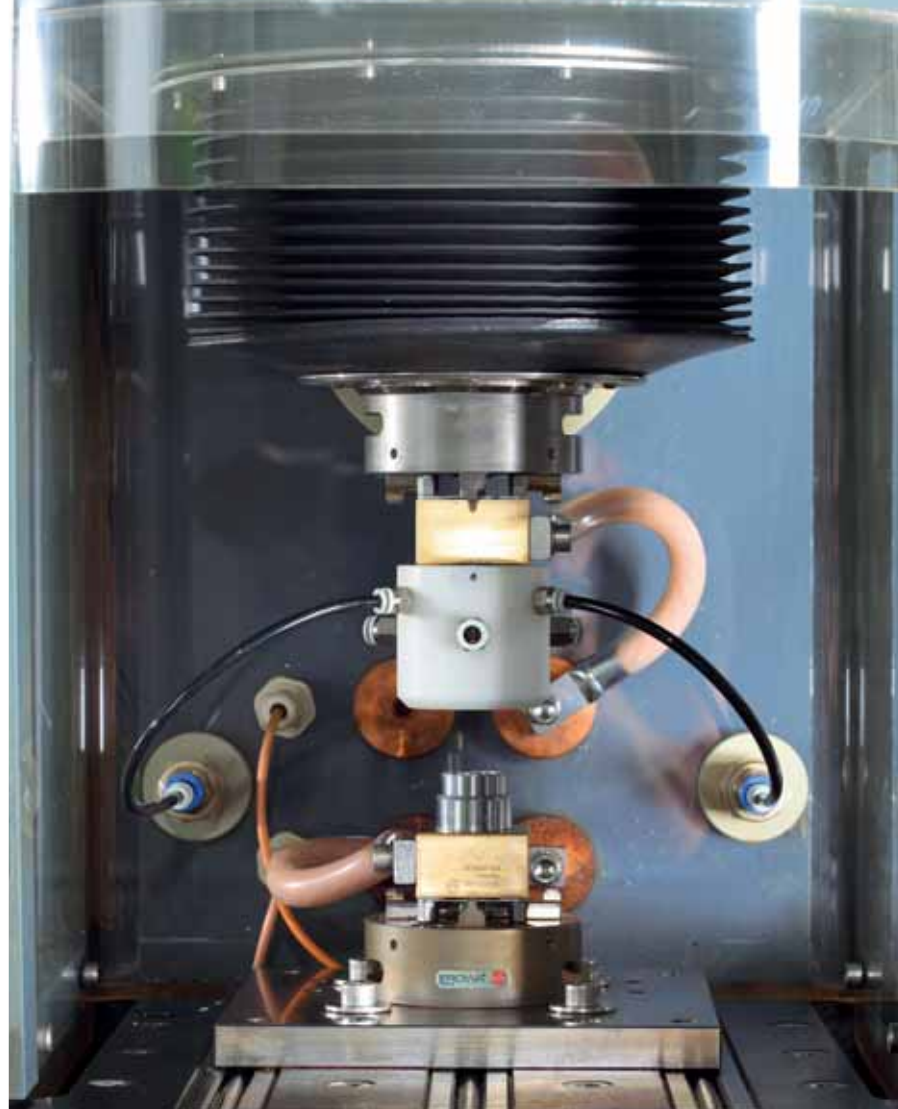
Die PEM 400 Compact eignet sich ideal für die Serienfertigung von Metallteilen mit einfachen bzw. mehrfachen Bearbeitungsschritten. Arbeitsraum und Maschinentisch sind 380 Millimeter breit und 500 Millimeter tief, die Stromstärke ist auf 1.000 Ampere beschränkt.
