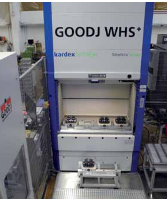
Im Turmspeicher, ein Kardex Remstar Shuttle, lagern Vorrichtungen und Paletten, rückseitig ist er ebenfalls zu beladen.
