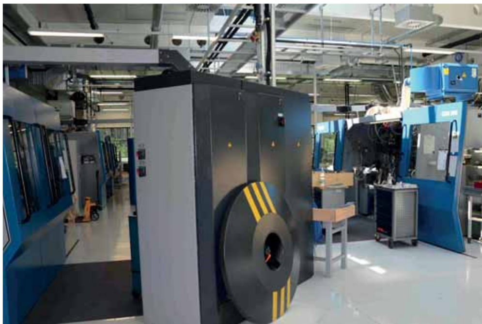
Sie produzieren bis zu 80.000 Kontakte am Tag: drei moderne Stanz-Biege-Zentren und zwei kleine Fertigungslinien.
