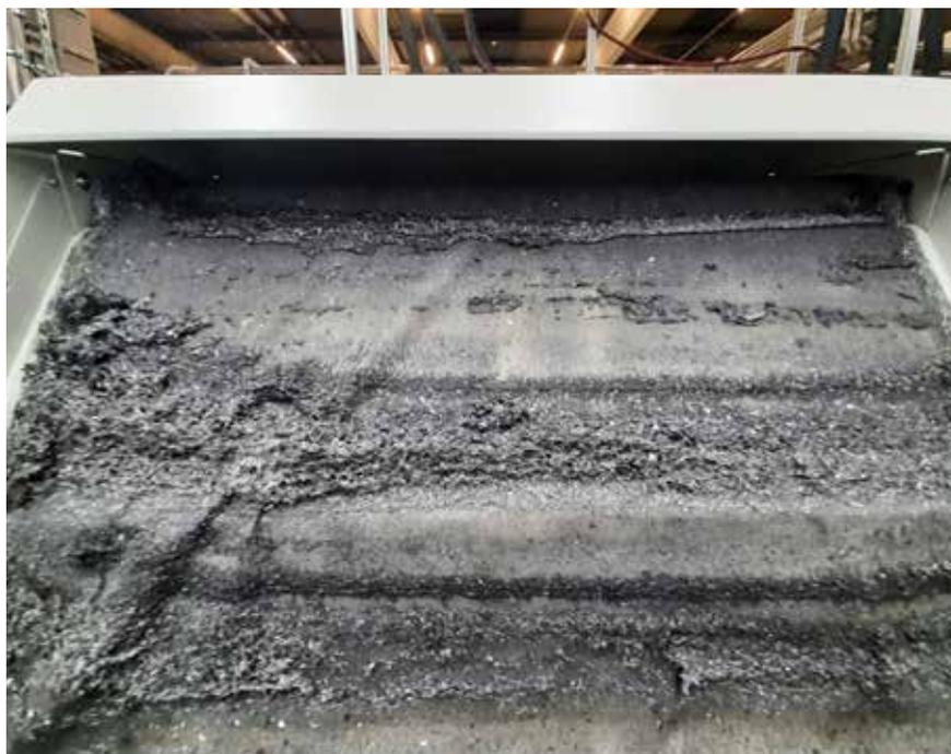
**Ausgetragener Frässhchlamm** der Aluminiumbearbeitung.
