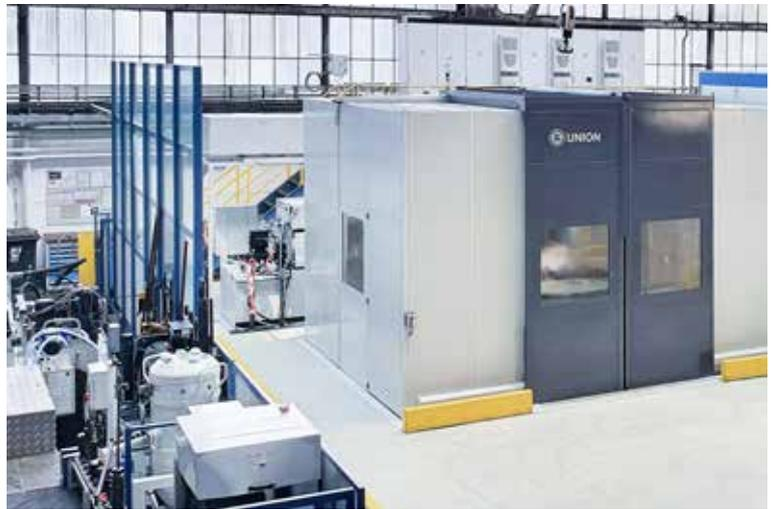
Um die Verfügbarkeit und Wirtschaftlichkeit für die nächsten Produktionsjahre weiterhin sicherzustellen, wurde die Maschine im Zuge einer Umsetzung von den WaldrichSiegen-Experten modernisiert. Dabei wurde eine – von Herkules Meuselwitz gefertigte – Kühlmittelkompaktanlage sowie eine Maschinenvollumhausung mit Absauganlage nachgerüstet, für bestmögliche Maschinensicherheit und Schutz der Mitarbeiter vor Staub, Kühlschmierstoff und Lärm.
