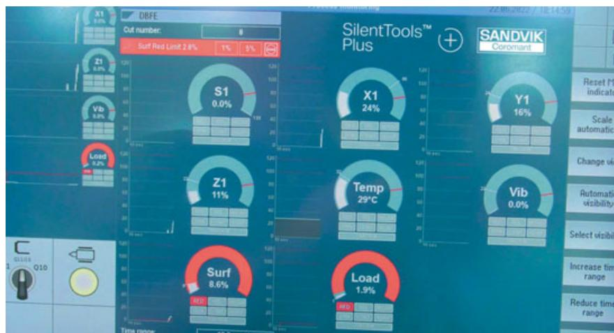
**Bild 2.** Auf dem Bildschirm werden präzise Daten für Belastung, Oberfläche, Vibrationen und Temperatur im Dämpfungssystem sowie die Schnittzeit gezeigt. Grafik: WFL
