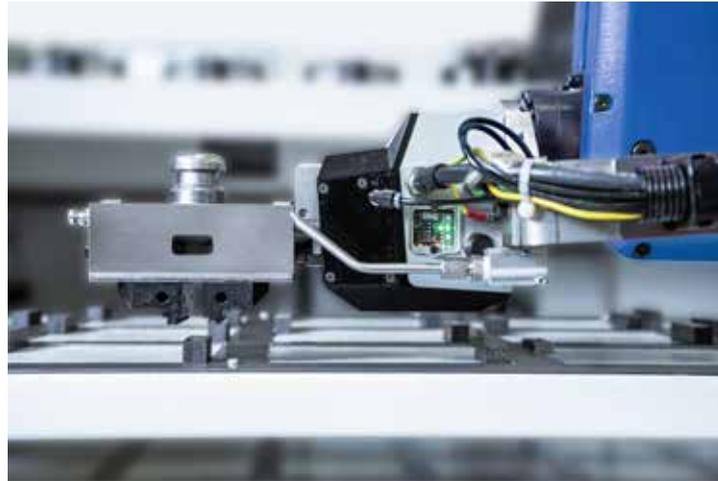
Mit der Werkstück-Automatation R-C2 zeigt Ceratizit das Bindeglied zwischen Palettenautomation und Roboter-Direktbeladung.
