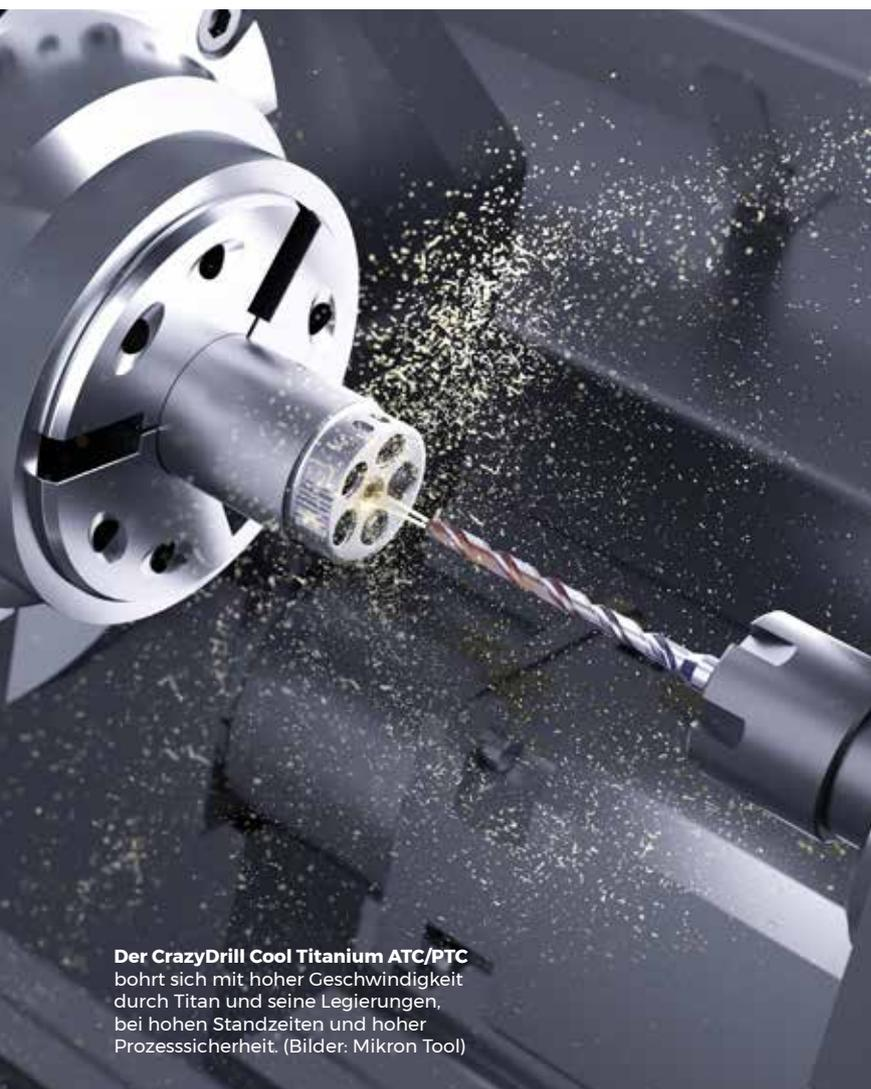
**Der CrazyDrill Cool Titanium ATC/PTC** bohrt sich mit hoher Geschwindigkeit durch Titan und seine Legierungen, bei hohen Standzeiten und hoher Prozesssicherheit. (Bilder: Mikron Tool)
