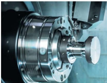
**Bild 1.** Das trochoidale Stechen eignet sich sehr gut für die Herstellung von tiefen und breiten Einstichen. Foto: Horn/Sauermann
