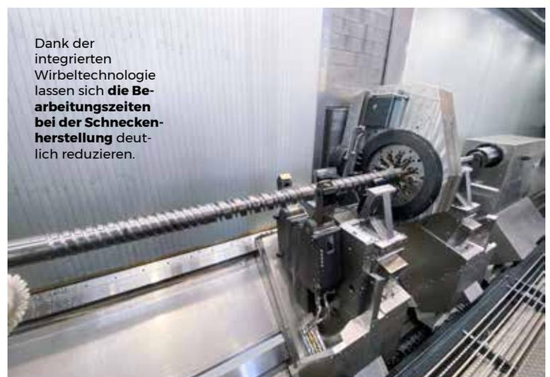
Dank der integrierten Wirbeltechnologie lassen sich **die Bearbeitungszeiten bei der Schneckenherstellung** deutlich reduzieren.
