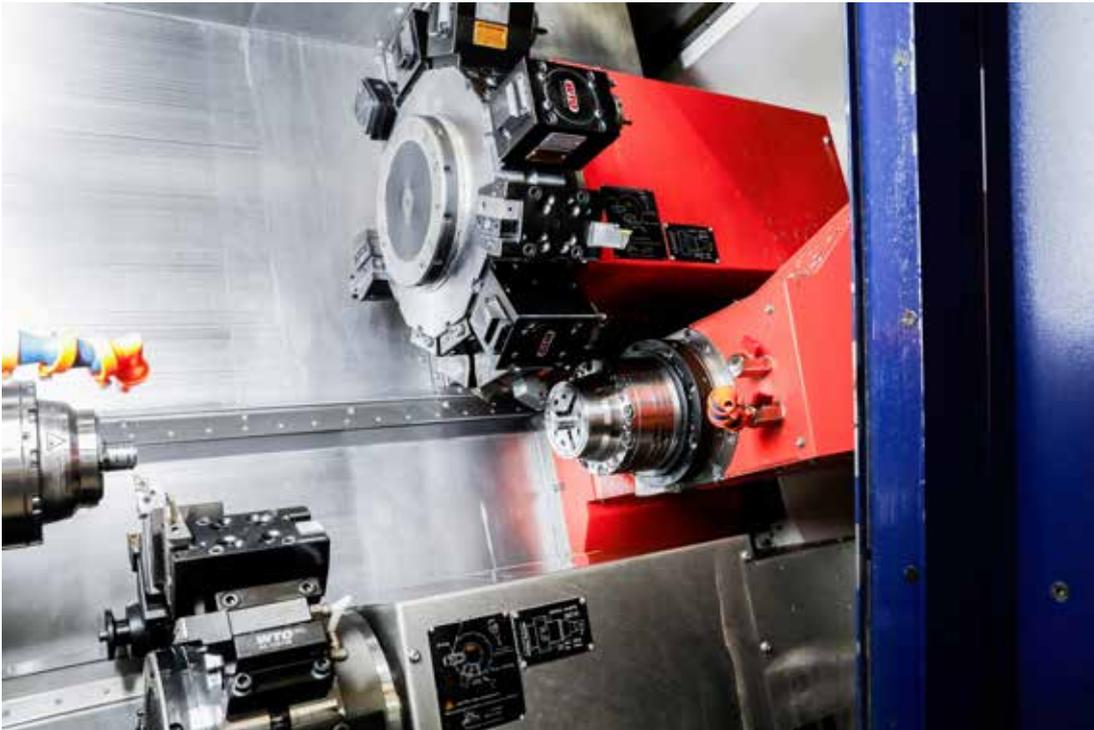
**Hohe Genauigkeiten gefordert:** Bei den beiden Passbohrungen der Stößelführung müssen Positionstoleranzen von  $+0,025$  mm zum Zylinder bzw. eine maximale Rauhtiefe von  $Rz = 8,0 \mu\text{m}$  eingehalten werden.
