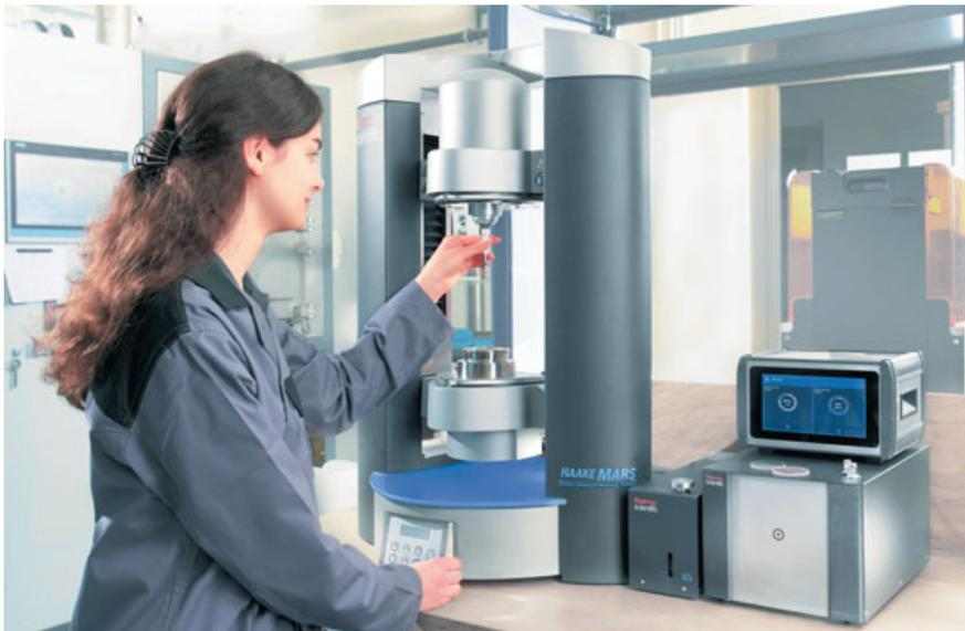
**Bild 3.** Rheometer mit angeschlossener Belichtungseinheit zur Bestimmung der Viskosität und des Aushärteverhaltens von Schlickerfeedstocks. Foto: KIT/wbk
