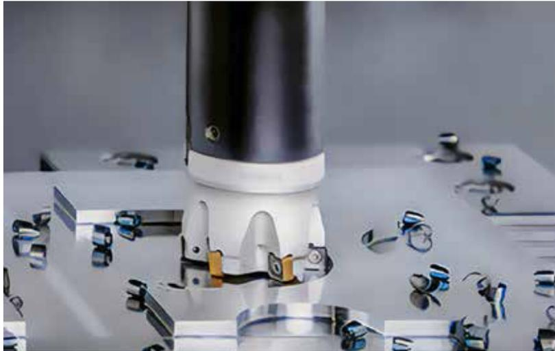
hat die NEODO S890-WSP speziell zum wirtschaftlichen Schruppen und Semifinishing von ISO-K- und ISO-P-Werkstoffen entwickelt. Die WSP besitzen acht wendelförmige, rechte Schneidkanten und einen Anstellwinkel von 90 Grad für hohe Performance bei einer maximalen Schnitttiefe von fünf Millimetern.
