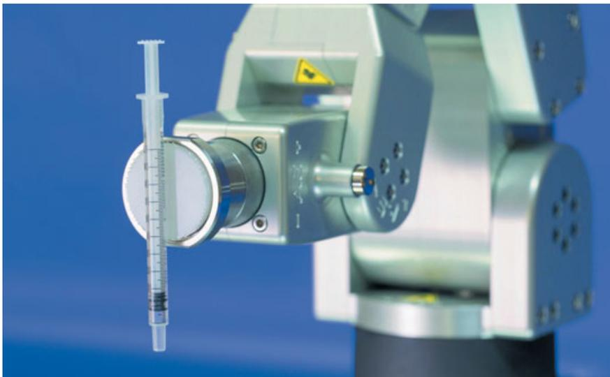
**Die Greifer von Innocite** bestehen aus tausenden feinen Polymer-Härchen. Mit ihrer Hilfe lassen sich winzige Bauteile ebenso anheben wie hohe Gewichte. Eingesetzt werden können sie also bei der Mikromontage von Elektronikbauteilen oder auch zum Versetzen von großen Maschinenbauteilen.
