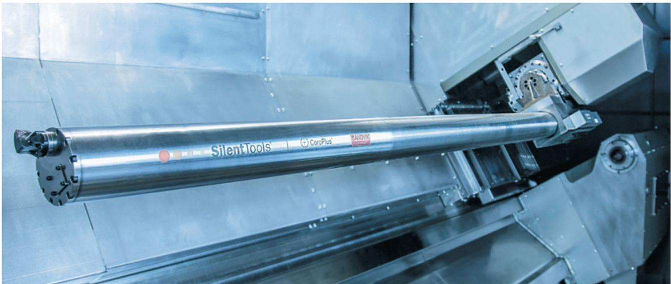
**Connected:** Die „Silent Tools Plus“-Bohrstange schafft eine Schnittstelle zwischen Werkzeug und Maschine und erlaubt eine automatisierte, digitale Bearbeitung. Foto: WFL
