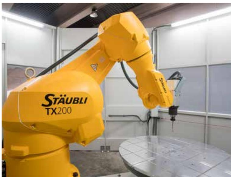
Werkzeug passt sich an die individuelle, sensorisch erfasste Position des Werkstücks an. Das gelingt, weil die externe Vermessung mit dem 3D-Scanner die reale Position des Werkstücks mit dem in der Steuerung hinterlegten 3D-Modell vergleicht. Die Robotersteuerung erhält dann als Input den „Offset“, den der Roboter bei der Positionierung des Werkzeugs und der Bearbeitung selbst berücksichtigt.
