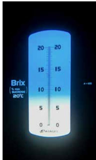
Regelmäßige Kontrolle ist wichtig. Die Messung der KSS-Konzentration mit dem Spektrometer **gewährleistet prozesssicheres Arbeiten in der Zerspanung.**
