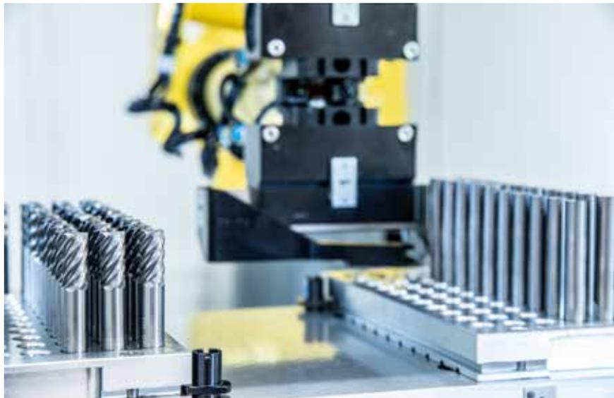
Der Roboter kann in chaotischer Folge bis zu **500 Rohlinge beziehungsweise Werkzeuge** von Paletten be- und entladen und der Schleifspindel zu-führen.
