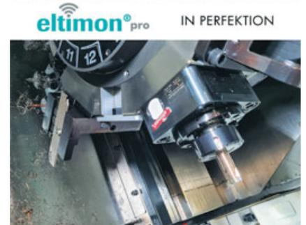
**Bild 2.** Den Drehprozess im „digitalen Griff“: Digitalisierte Werkzeughalter für Drehmaschinen sorgen für kostenoptimierte, vorbeugende Instandhaltung und Prozesssicherheit. Grafik: mimatic
