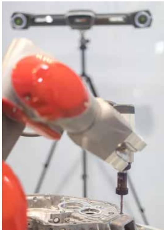
Ein exaktes, d. h. ein **gerades Eintauchen in das Bohrloch**, ermöglicht die Schrägstellung des Werkzeuges nach Empfang der 3D-Scannersignale.
