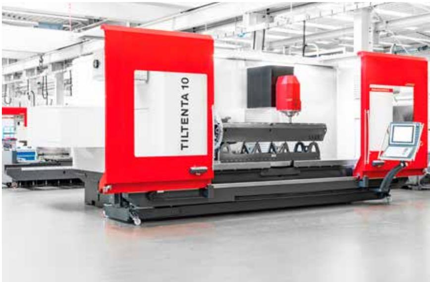
**5-Achs-Bearbeitungszentrum Tiltenta 10-3600** mit stufenlos schwenkbarer Hauptspindel, 1.000 mm großen Y- und Z-Verfahrwegen, SK50 BIG PLUS-Hauptspindel sowie integrierten Schwerlasttischen mit 2.200 kg Aufspanngewicht.
