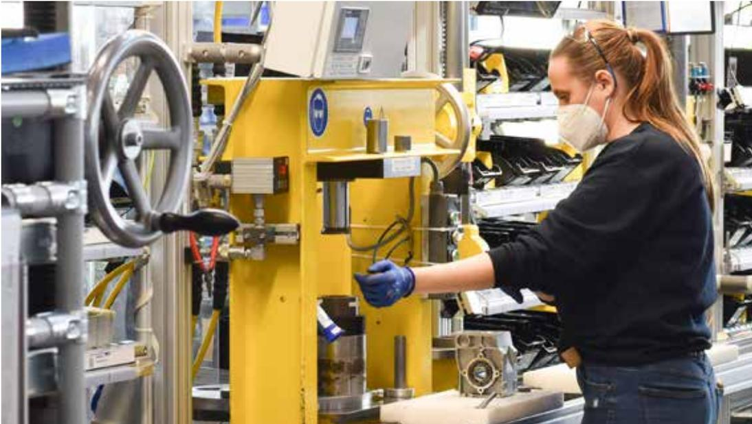
**Mitarbeiter von Lenze Austria in Asten montieren jährlich mehr als 100.000 Getriebemotoren.** Die Verbindung zwischen Motor und Getriebe erfolgt kraftschlüssig über ein Ritzel, das in die Motorwelle eingepresst wird.
