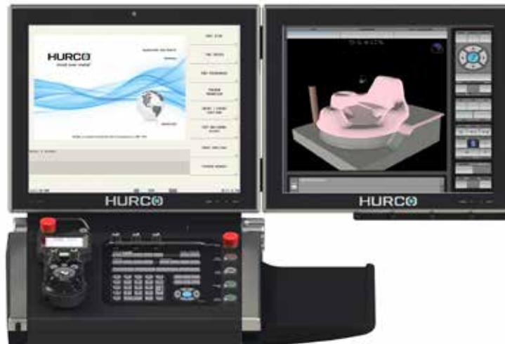
Mit der Option **Surfacing** lassen sich mit der Hurco-Steuerung Freiformflächen direkt an der Maschine programmieren.
