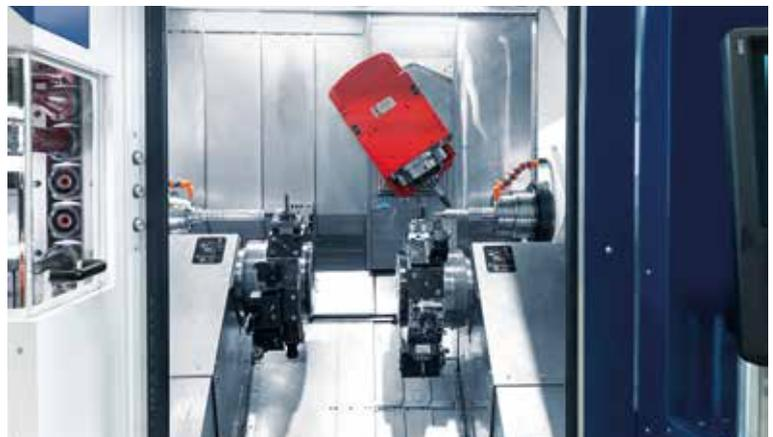
**Haupt- und Gegenspindel:** Mit 29 (37) kW und 250 (360) Nm bietet die Hauptspindel ausreichend Power, um Stangenteile bis  $\varnothing 65$  (76,2/95) mm und Futterteile bis  $\varnothing 250$  mm wirtschaftlich zu bearbeiten. Die verfahrbare Gegenspindel bietet die gleichen Leistungsdaten wie die Hauptspindel.
