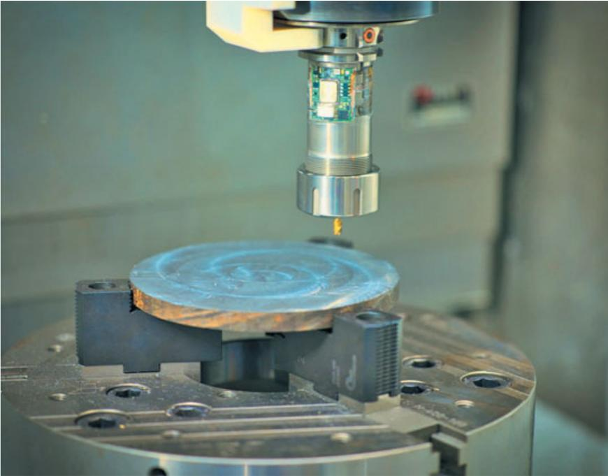
**Bild 2.** Die Entwicklung des smartTOOL geht weiter, die nächste Generation wird „kürzer bauen“ und über eine noch leistungsfähigere Sensorik sowie Signalaufbereitung verfügen. Foto: Fraunhofer IWU
