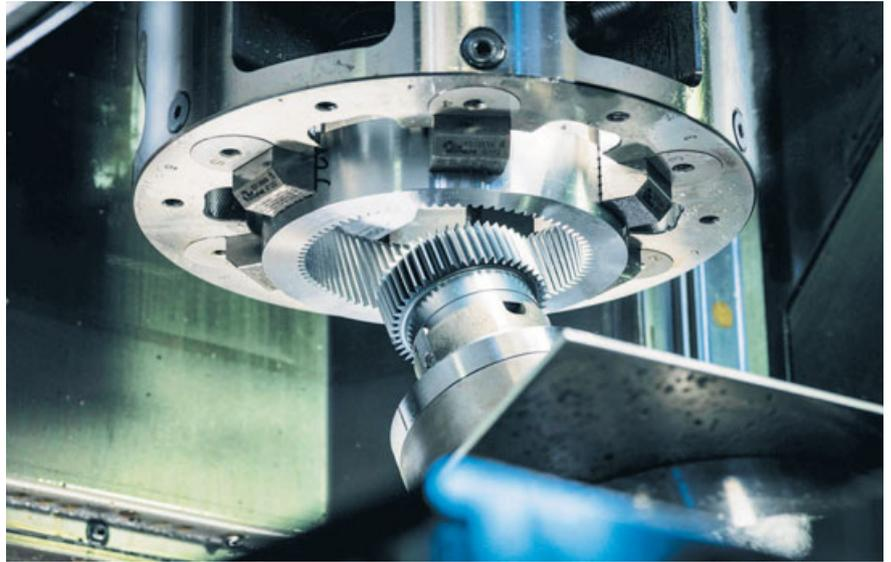
**Bild 4.** Das am wbk Institut für Produktionstechnik zur Serienreife entwickelte Wälzschalen gestattet die hochproduktive und flexible Fertigung der gezeigten Zahnräder. Foto: wbk
