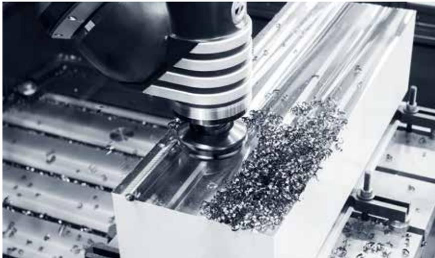
und Zuverlässigkeit. Der Inline-Motor mit einer Leistung von 32 kW bei S1 – 100 % Einschaltdauer und einer maximalen Drehzahl von 7.000 min<sup>-1</sup> ist wassergekühlt, um eine optimale thermische Stabilität zu gewährleisten.
