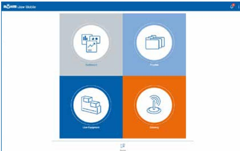
**Oberfläche der iJaw Mobile App:** Über das Dashboard kommt man zu den Live-Daten des laufenden Bearbeitungszyklus. Unter Projekte kann man die Produktion von Werkstücken einrichten. iJaw Equipment zeigt alle verfügbaren Backen, Spanneinsätze und Zubehörteile an. Via Gateway stellt man die Verbindung zwischen Backe und dem Modul iJaw Connect her.
