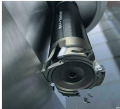
Topologieoptimierter Fräskopf, gedruckt aus Titan: „Coromill 390“ von Sandvik. Foto: Sandvik
