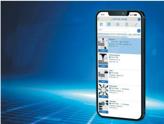
**Digitale Unterstützung:** Der „Tool Adviser“ erleichtert die Suche nach dem passenden Werkzeug. Auf Grundlage technischer Analysen und Expertenwissen erzeugt dieses System eine Reihe von effizienteren Lösungen mit geeigneten Schnittdaten und gibt dem Nutzer einen direkten Zugriff auf den E-Katalog. Foto: Iscar
