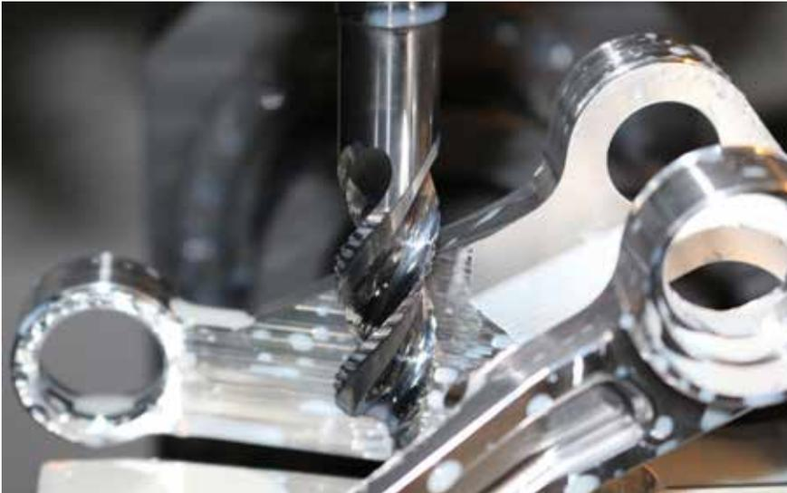
Der MegaAlu Power-Fräser sorgt für **Prozesssicherheit beim Konturschruppen des Umlenkhebels.**
