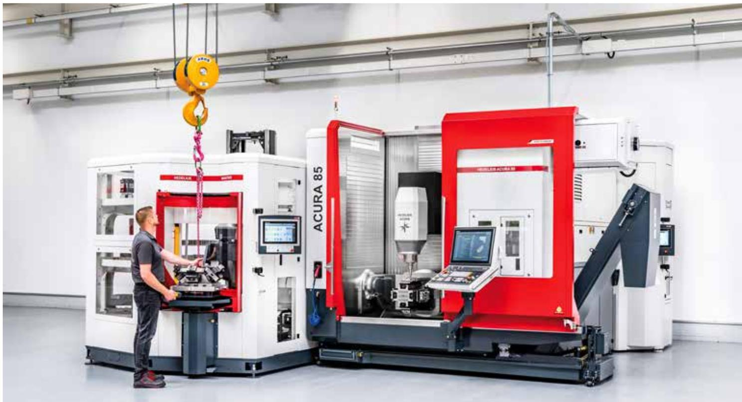
**Eingespieltes Team für hohe Produktivität:** 5-Achs-Bearbeitungszentrum Acura 85 mit Standby-Magazin für insgesamt 344 Werkzeuge und 18-fach Palettenspeicher mit 18 Paletten à 500 x 500 mm, 700 mm Störkreis und 470 kg Transfergewicht.
