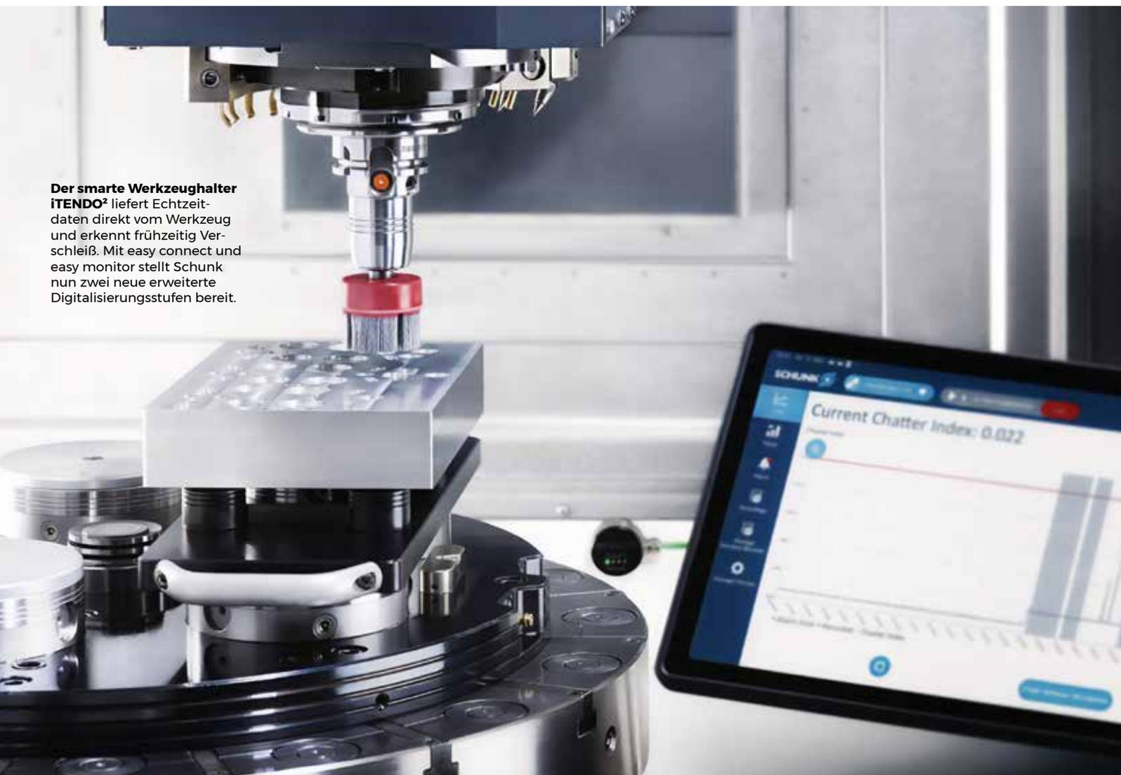
**Der smarte Werkzeughalter iTENDO<sup>2</sup>** liefert Echtzeitdaten direkt vom Werkzeug und erkennt frühzeitig Verschleiß. Mit easy connect und easy monitor stellt Schunk nun zwei neue erweiterte Digitalisierungsstufen bereit.
