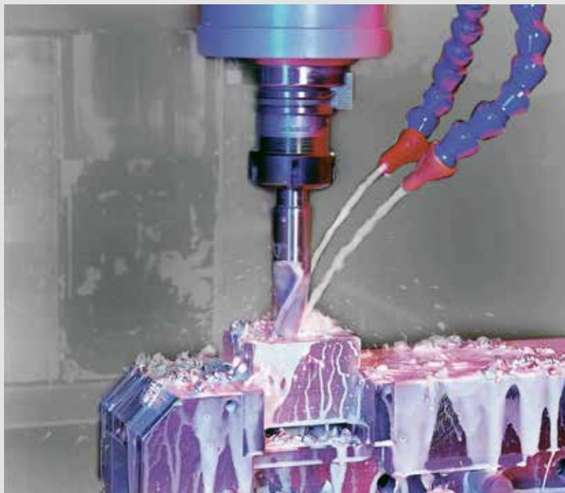
**Mit einer hohen Waschwirkung** hält der Bonderite L-MR 21718 Maschinen, Teile und Späne sauber.
