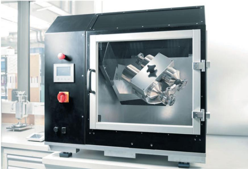
**Bild 2.** Zwei-Achs-Mischer mit frei einstellbarer Drehzahl und unabhängig einstellbarer Drehrichtung zur Mischung von bis zu vier verschiedenen Feedstocks gleichzeitig und 20 kg Zuladung. Foto: KIT/wbk
