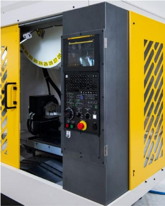
Für das Bearbeitungszentrum **ROBODRILL** sind eine ganze Reihe von Neuerungen wie der längere Y-Achsen-Hub von 500 mm oder das Werkzeugwechselsystem mit 28 Werkzeugplätzen verfügbar.
