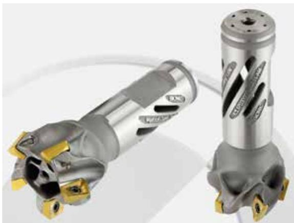
Mit der neuen Werkzeuggeneration CUBE BIONIC von Ingersoll lassen sich durch generatives Design bei bedarfsgerechter Stabilität bis zu 70 % des Werkzeuggewichts einsparen.
