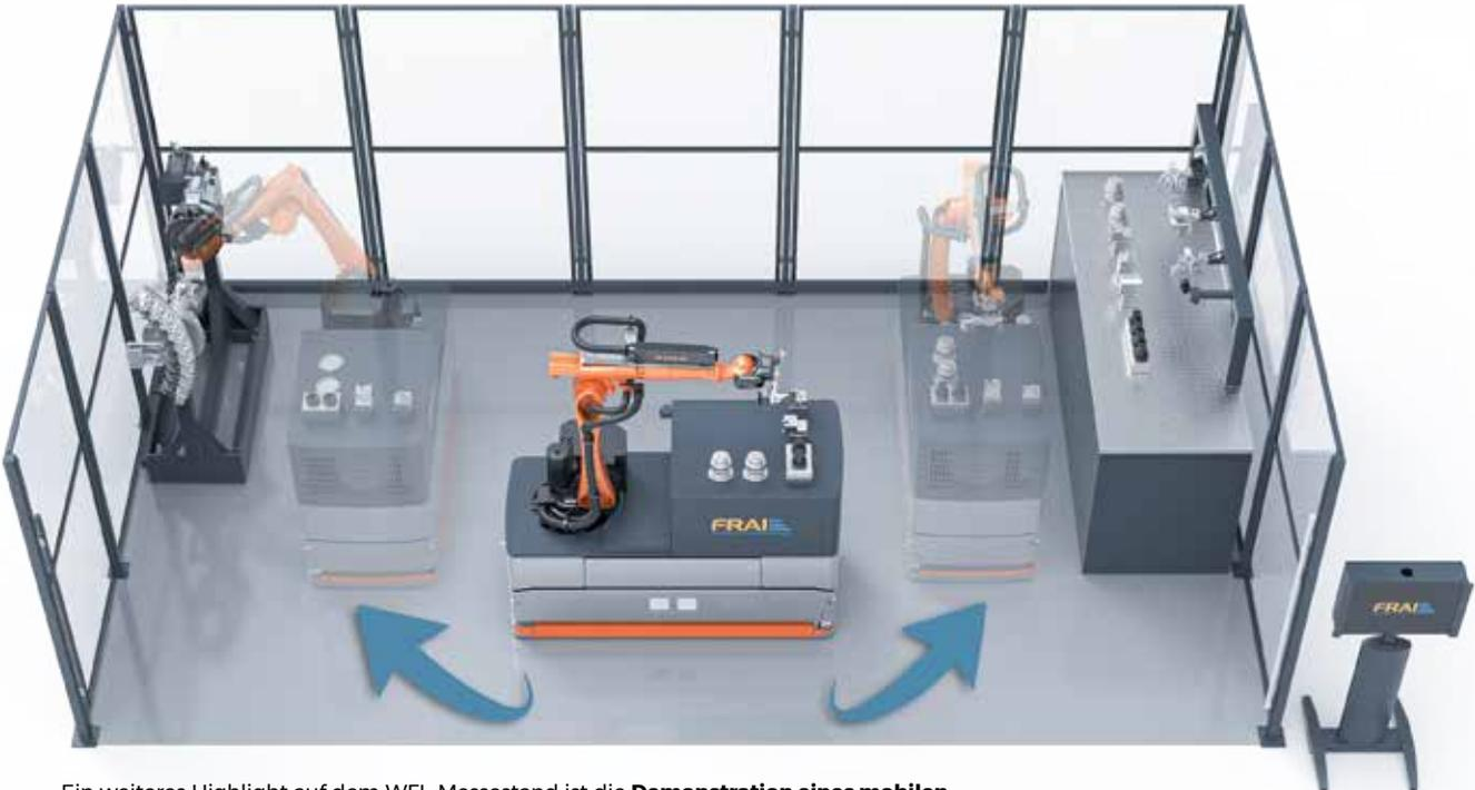
Ein weiteres Highlight auf dem WFL-Messestand ist die **Demonstration eines mobilen Roboters**, welcher auf einem FTF (Fahrerloses Transportfahrzeug) aufgebaut ist. Demonstriert wird dabei das Ein- und Auswechseln von Werkzeugen und Werkstücken.
