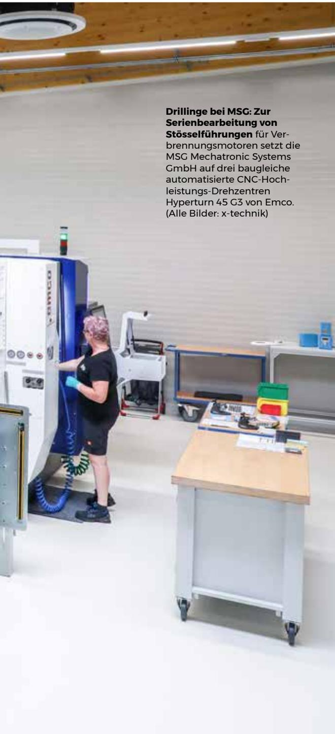
**Drillinge bei MSG: Zur Serienbearbeitung von Stößelführungen** für Verbrennungsmotoren setzt die MSG Mechatronic Systems GmbH auf drei baugleiche automatisierte CNC-Hochleistungs-Drehzentren Hyperturn 45 G3 von Emco. (Alle Bilder: x-technik)
