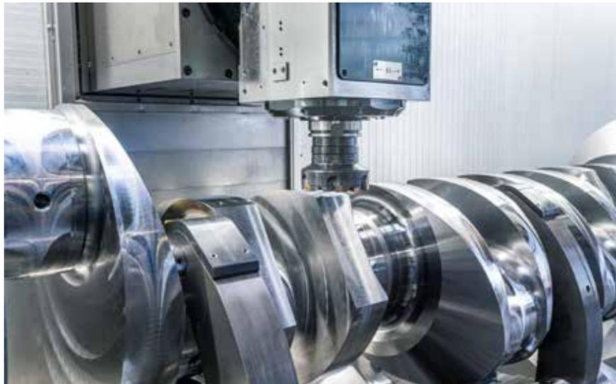
**Die mpmc-Baureihe kann für die Zerspaltung von Werkstücken von bis zu 60 Tonnen bei einer Drehlänge von 15 Meter und einem Werkstückdurchmesser von bis zu 2,0 Meter geliefert werden.**
