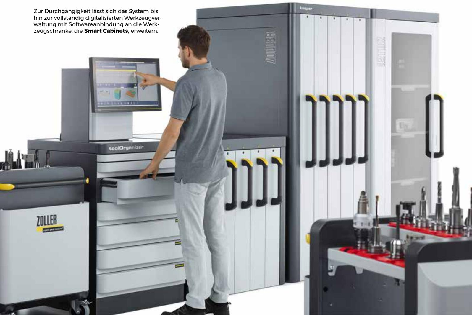
nenbediener das Etikett mit der Werkzeug-ID an der CNC-Maschine scannt, holt sich die Maschine die Daten direkt aus der Datenbank.
