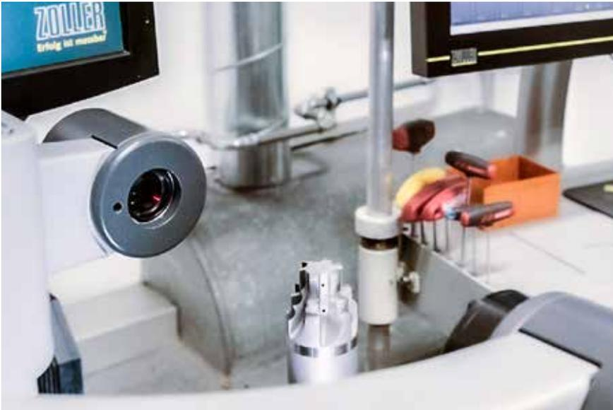
In der Werkzeugvorbereitung werden sämtliche Werkzeuge **genau vermessen und dokumentiert**.
