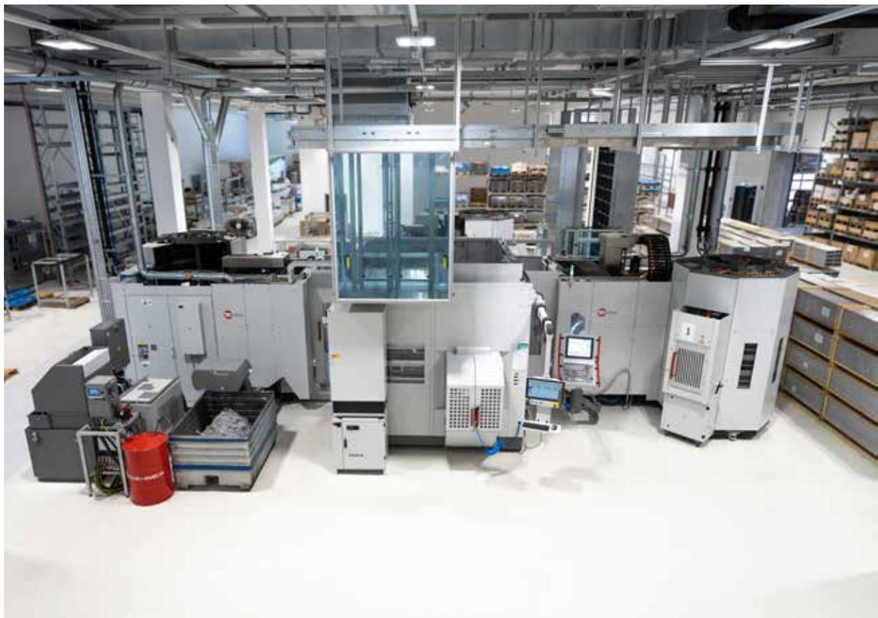
Der moderne Maschinenpark erlaubt es Heron CNC Technik, präzise und effizient zu fertigen. **Mithilfe des Fluidmanagement-Systems ZG Fluid-Check Pro** wird nun auch die Kühlschmierstoffzufuhr von Maschinen und Anlagen automatisiert überwacht, organisiert und gesteuert.
