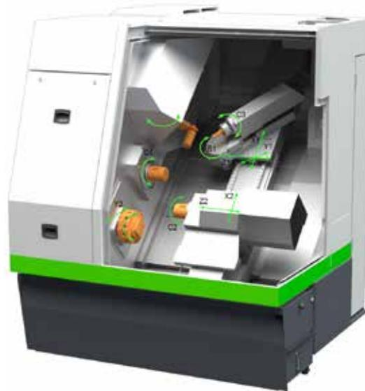
Auf den zur EMO erstmals vorgestellten Dreh-Fräszentren GOFuture B6X haben die Spezialisten von Benzinger einen Werkzeugrevolver mit einer schwenkenden Fräseinheit kombiniert, die auch simultan Werkstücke in Haupt- und Gegen spindle bearbeiten können.
