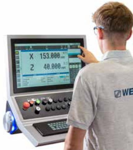
Die für Weiler Zykeldrehmaschinen auf Basis der Siemens Sinumerik ONE **neu entwickelte Bedienoberfläche „one1“** vereinfacht sowohl das manuelle als auch das zyklengesteuerte Drehen.
