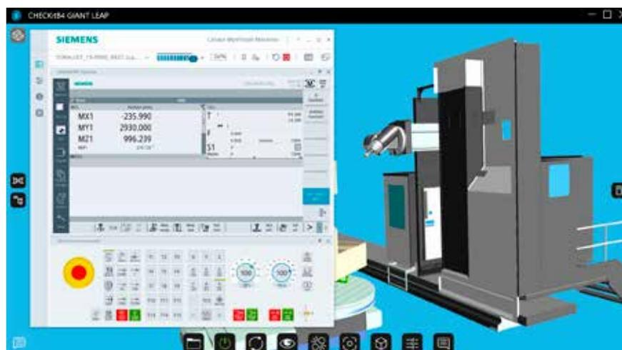
Mit CHECKitB4 können auch von komplexeren CNC-Maschinen Digitale Zwillinge erstellt werden. **Dabei spielt die Anzahl der Achsen und Wechsel-Aggregate keine Rolle.**
