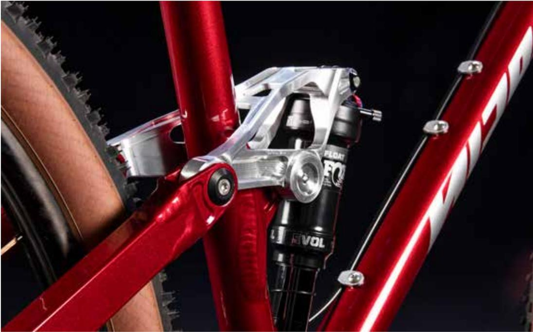
**Der Umlenkhebel** steuert bei gefederten Bikes den Hinterraddämpfer an. So steif wie nötig, so leicht wie möglich, lautet hierbei die Devise. (Bild: Nicolai)
