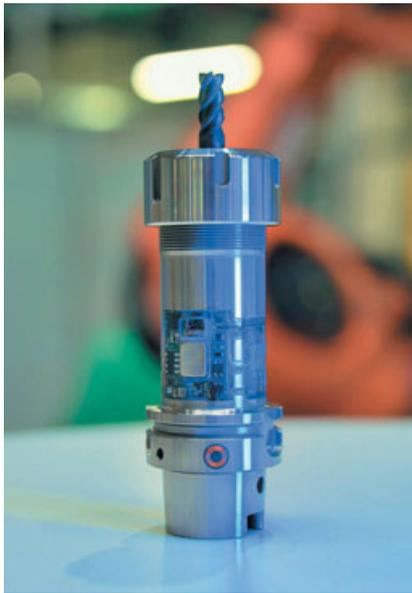
**Bild 1.** smartTOOL überträgt wichtige Prozessdaten kabellos und erfordert keine zusätzliche Stromversorgung. Foto: Fraunhofer IWU
