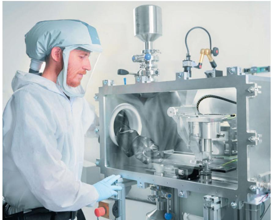
**Bild 1.** Eigenentwickelter Beschichtungsprüfstand zur detaillierten Untersuchung des Feedstockfließverhaltens und zur Entwicklung neuer Beschichtungstechniken. Foto: KIT/wbk
