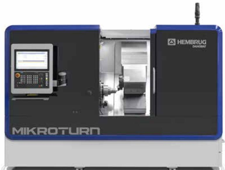
Die MikroTurnGrind-100 wurde von Hembrug entwickelt, um Dreh- und Schleiffunktionen für komplexe Bearbeitungsaufgaben zu kombinieren.
