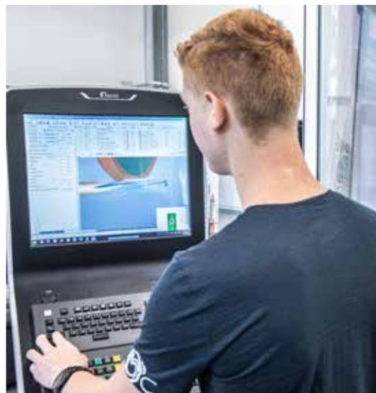
An der Werkzeugschleifmaschine erhält das Fachpersonal **eine vollständige 3D-Simulation** der Maschinenbewegungen einschließlich der Werkzeugwechsel, um den Schleifablauf zu prüfen und zu verifizieren.
