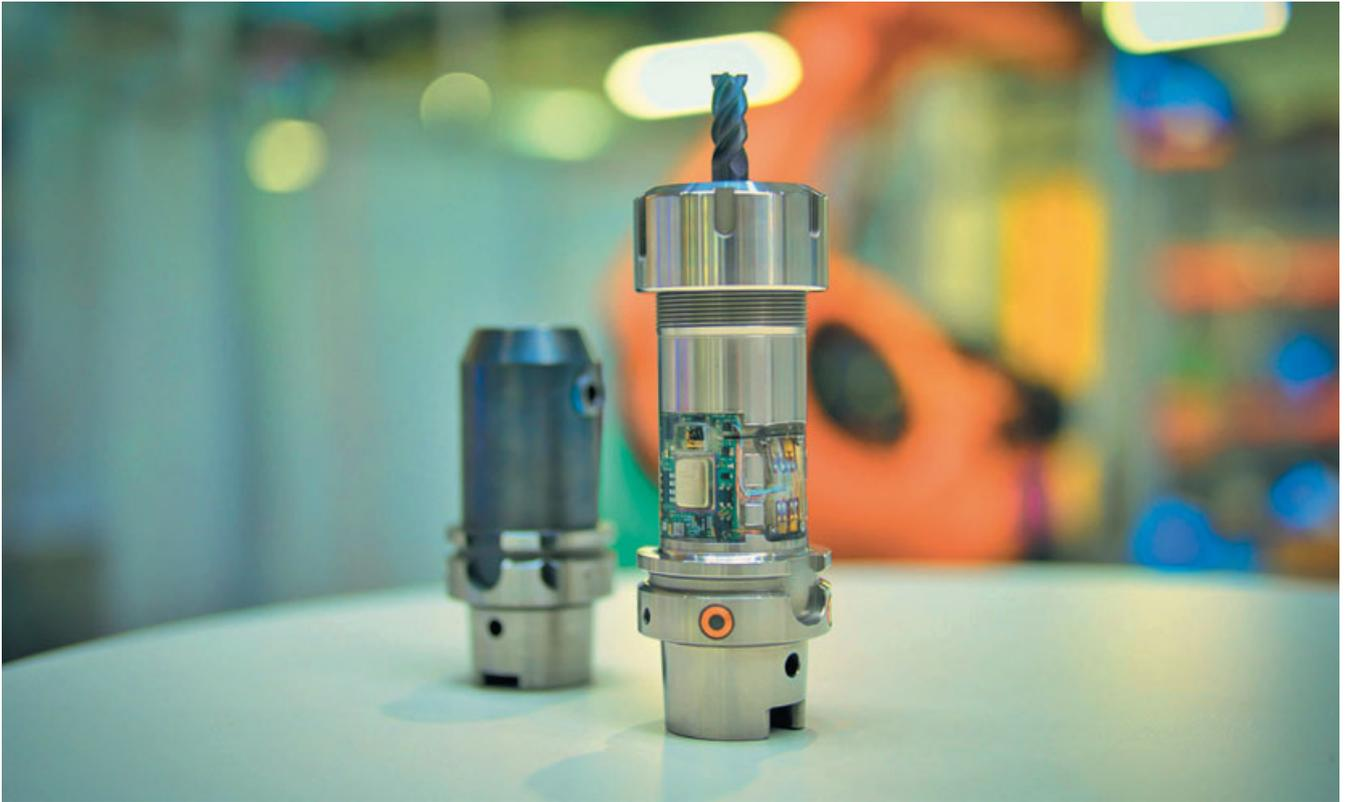
**Größenvergleich:** „smartTOOL“ der intelligente Werkzeughalter, beansprucht kaum mehr Bauraum als ein konventionelles Modell und ist ebenso universell einsetzbar sowie einfach integrierbar. Foto: Fraunhofer IWU
