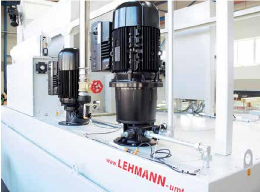
**Energieeffiziente Frequenzumrichterregelung an Pumpen der Zentralanlage:**
