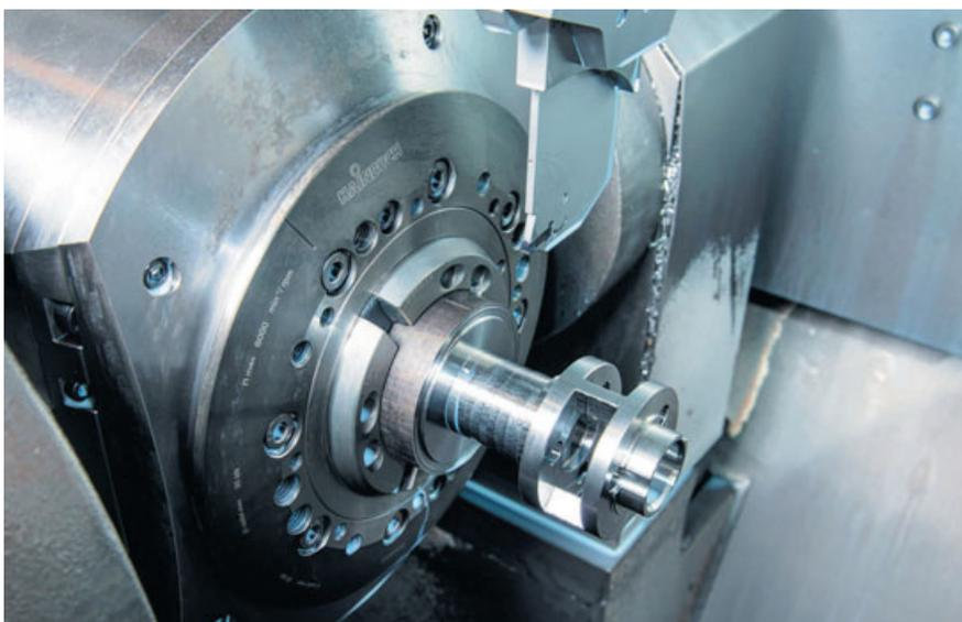
**Bild 3.** Höhere Vorschübe bei gleicher Stechbreite erlaubt das Horn-Stechsystem zum Einstechen über die Y-Achse. Foto: Horn/Sauermann
