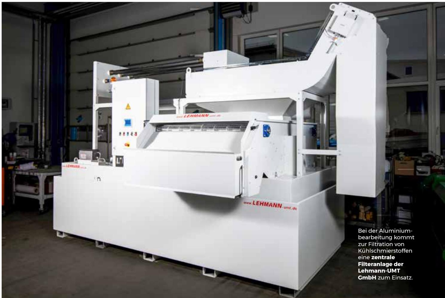
Bei der Aluminiumbearbeitung kommt zur Filtration von Kühlschmierstoffen eine **zentrale Filteranlage der Lehmann-UMT GmbH** zum Einsatz.
