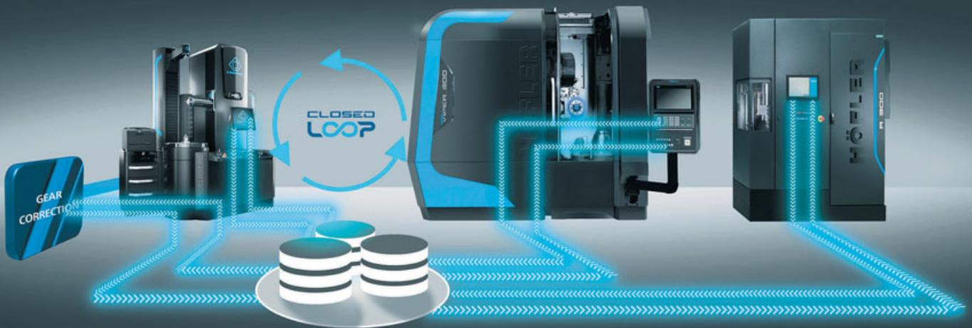
**Bild 1.** Mithilfe des Closed Loop ist eine engmaschige Überwachung und Korrektur des Fertigungsprozesses möglich – für eine 100-prozentige Prüfung aller geschliffenen Teile. Grafik: Klingelberg
