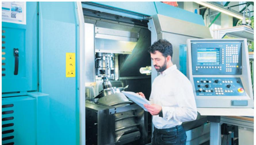
**Bild 5.** Mit einer echtzeitfähigen Zahnrad-Profilprognose kann die Auswirkung der Bearbeitungskräfte auf die Verzahnungsqualität prognostiziert und korrigiert werden. Foto: wbk
