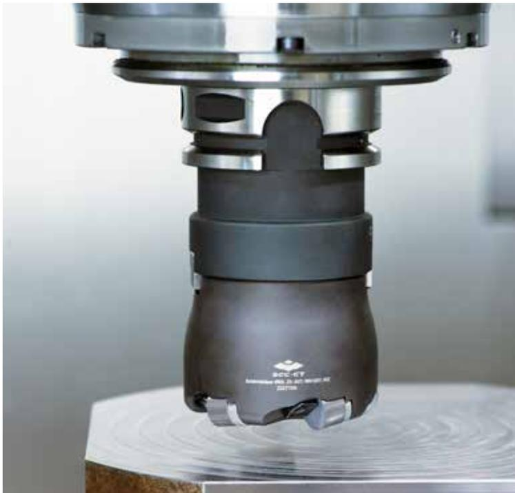
**CSX1000 ist eine High-Performance-Sorte** aus der neuesten Generation der SiAlON-Keramikschneidstoffe und kombiniert Zähigkeit mit Verschleißfestigkeit, z. B. auf dem FMR06-Rundplattenfrässystem von ZCC Cutting Tools Europe.
