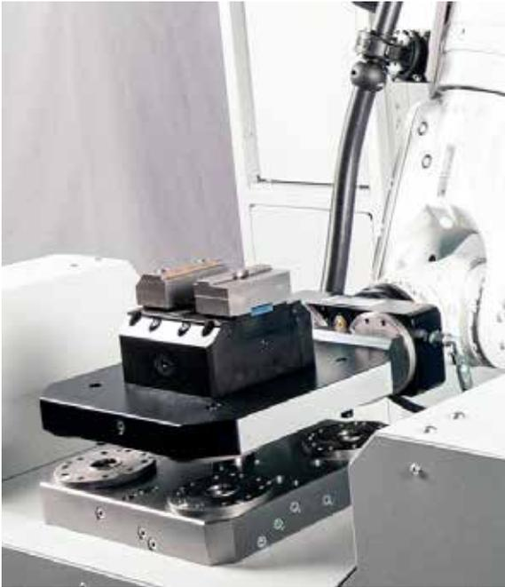
**Die Spannmittel mit integrierter Messintelligenz von Hainbuch** ermöglichen eine In-Line-Messung. Sie messen kontinuierlich Werkstückdurchmesser, Temperatur, Werkstückanlage und Spannkraft.
