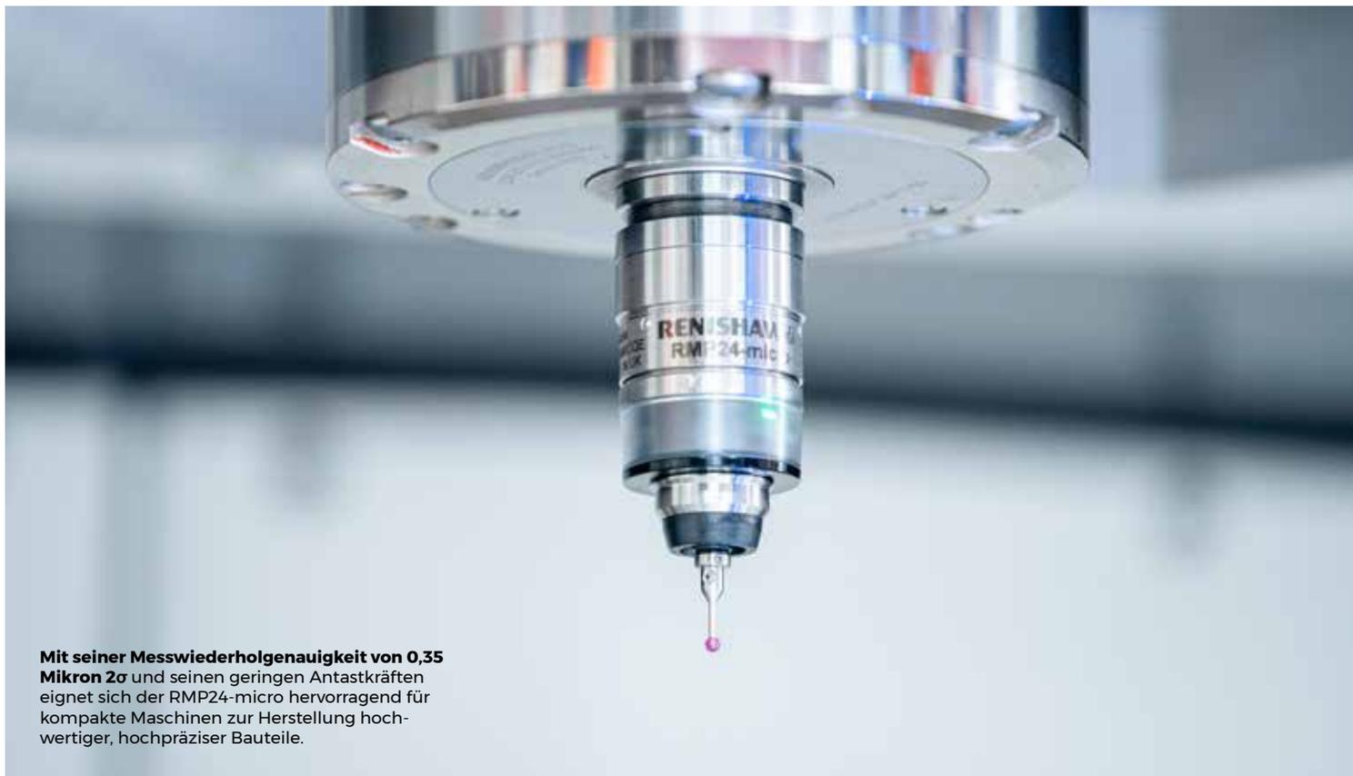
Mit seiner Messwiederholgenauigkeit von **0,35 Mikron 2 $\sigma$**  und seinen geringen Antastkräften eignet sich der RMP24-micro hervorragend für kompakte Maschinen zur Herstellung hochwertiger, hochpräziser Bauteile.
