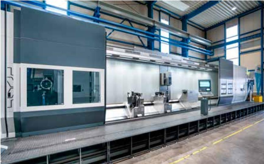
**Die Werkzeugmagazine sind bei den neu designten mpmc-Zentren nicht mehr im Rückraum, sondern jetzt je nach Wunsch stirnseitig am rechten oder linken Ende der Maschine angeordnet und können von vorne bestückt werden.**
