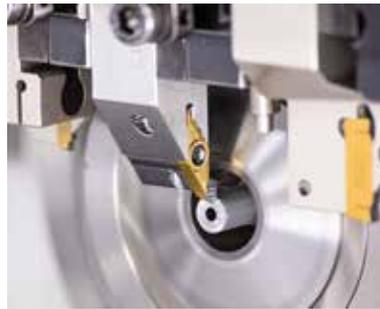
Dank zweier spezieller Spanformer erlauben die neuen WSP beim Drehen von Kleinbauteilen einen weichen Schnitt, hervorragende Oberflächenqualitäten und eine lange Standzeit.
