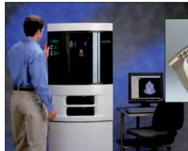
Häufig entscheidet man sich dafür, ein Modell in Originalgröße herzustellen – ein kostenintensives Unterfangen. Mit modernsten CAD-Programmen lassen sich sog. Rapid Prototyping Machines steuern, die ein Muster in nur wenigen Stunden entstehen lassen.
