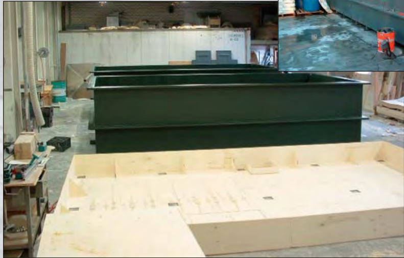
Polyesterbehälter können in nahezu jeder Größe hergestellt werden. Hier entstehen Behälter aus Polyester mit einem Holzkern. Anwendungsbereiche: u.a. Wasseraufbereitung, Fischzucht, Galvanisieren.
