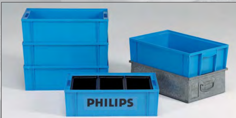
Im Auftrag von Philips haben wir einen Normbehälter aus Kunststoff entwickelt. Dieser wird gemeinsam mit den alten und schwereren Modellen aus Stahl verwendet und zeichnet sich durch den glatten Boden, den genau rechteckigen Innenraum und den Etikettenhalter im DIN-A7-Format an einer kurzen Seite aus.
