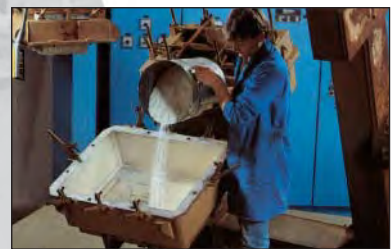
Einfüllen des Kunststoffpulvers in die Form. Danach wird diese fest verschlossen.
