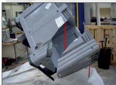
Bei der Sturzprüfung wird die maximale Belastbarkeit ermittelt.
