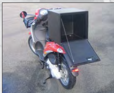
Der Rotationsguss eignet sich hervorragend für die Produktion von großen (Auffang-)Wannen und Tanks. Aber auch kleine Behälter, wie hier die Motorroller-Aufsätze der Belgischen Post werden im Rotationsgussverfahren hergestellt. Alles nach Maß!
