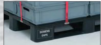
Sicherung von Behältern auf Paletten.
