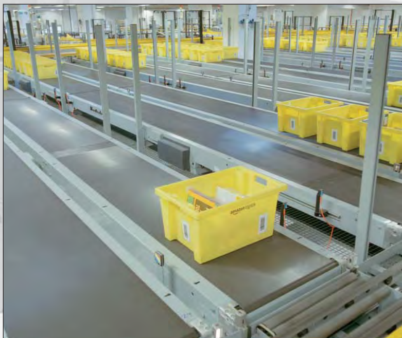
Die ESA-Behälter in einem Distributionssystem für Bücher und CDs. (Foto: Vanderlande Industries, NL)
