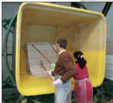
Produktion eines Polyesterbehälters (Einbringen der Glasfasermatten).
