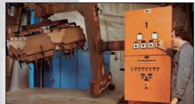
An einem Rotationsarm befinden sich meist mehrere Formen.
