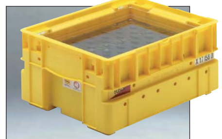
Dieser VDA-Transportbehälter schützt den Inhalt aus unbehandeltem Stahl wirkungsvoll vor Korrosion. Dies wird durch das Ausschwitzen von einigen Milligramm ECM erreicht. Voraussetzung ist, dass der Behälter mit einem Deckel (hier aus transparentem PET) versehen ist.
