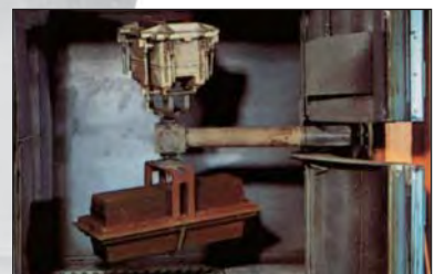
Die Formen werden jetzt im Ofen erhitzt und drehen sich permanent dabei (horizontal und vertikal).
