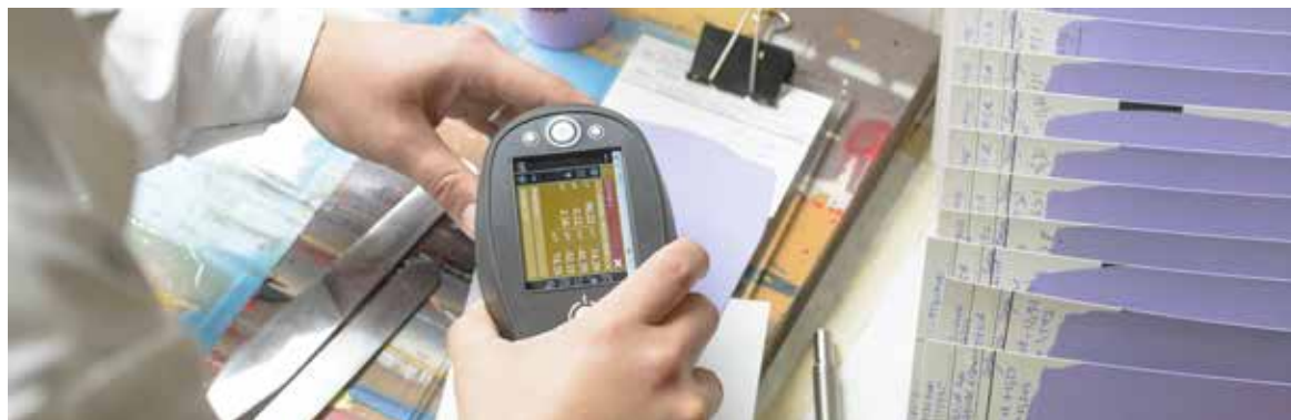
Espectrofotómetro de esfera portátil X-Rite Ci64
