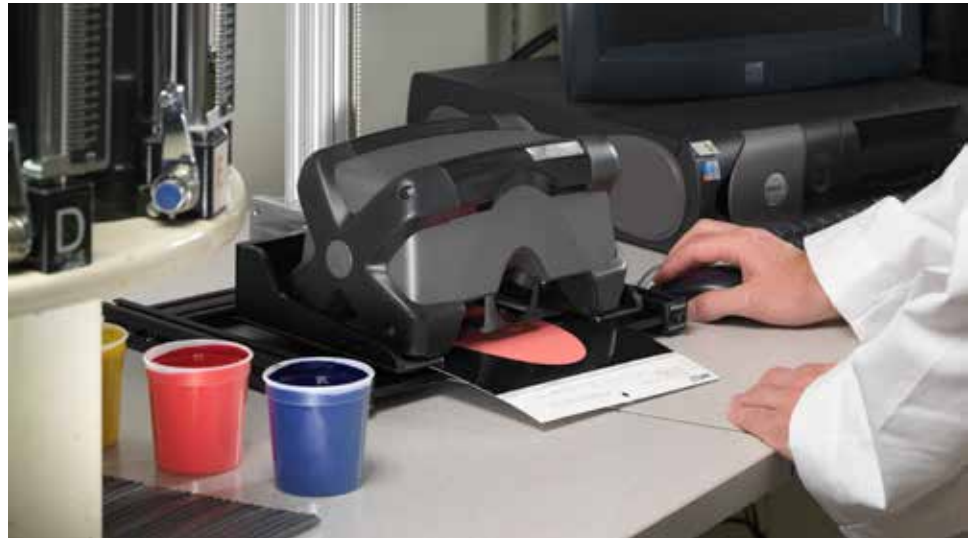
Espectrofotómetro VS450 de tipo 45°/0°
