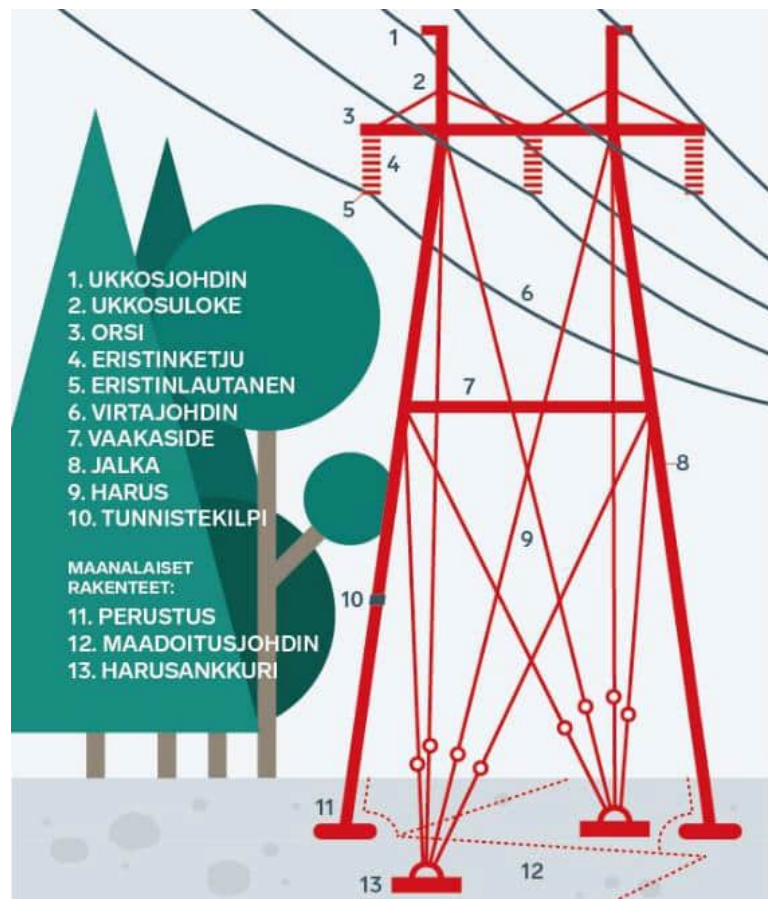
Kuva 3-4. Voimajohdon osat (Fingrid 2023b).
