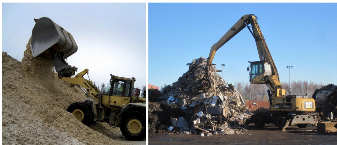
Kuva 2-5. Kauhakuormajan ja kahmarikoneen työskentelyä (Kuusakoski Oy 2014).
