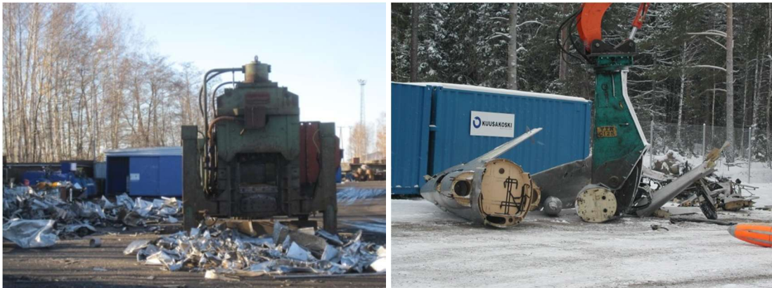
Kuva 2-15. Toiminnassa käytettävät mekaaniset leikkurit: liikuteltava leikkuri ja nokkaleikkuri (Kuusakoski Oy 2015).
