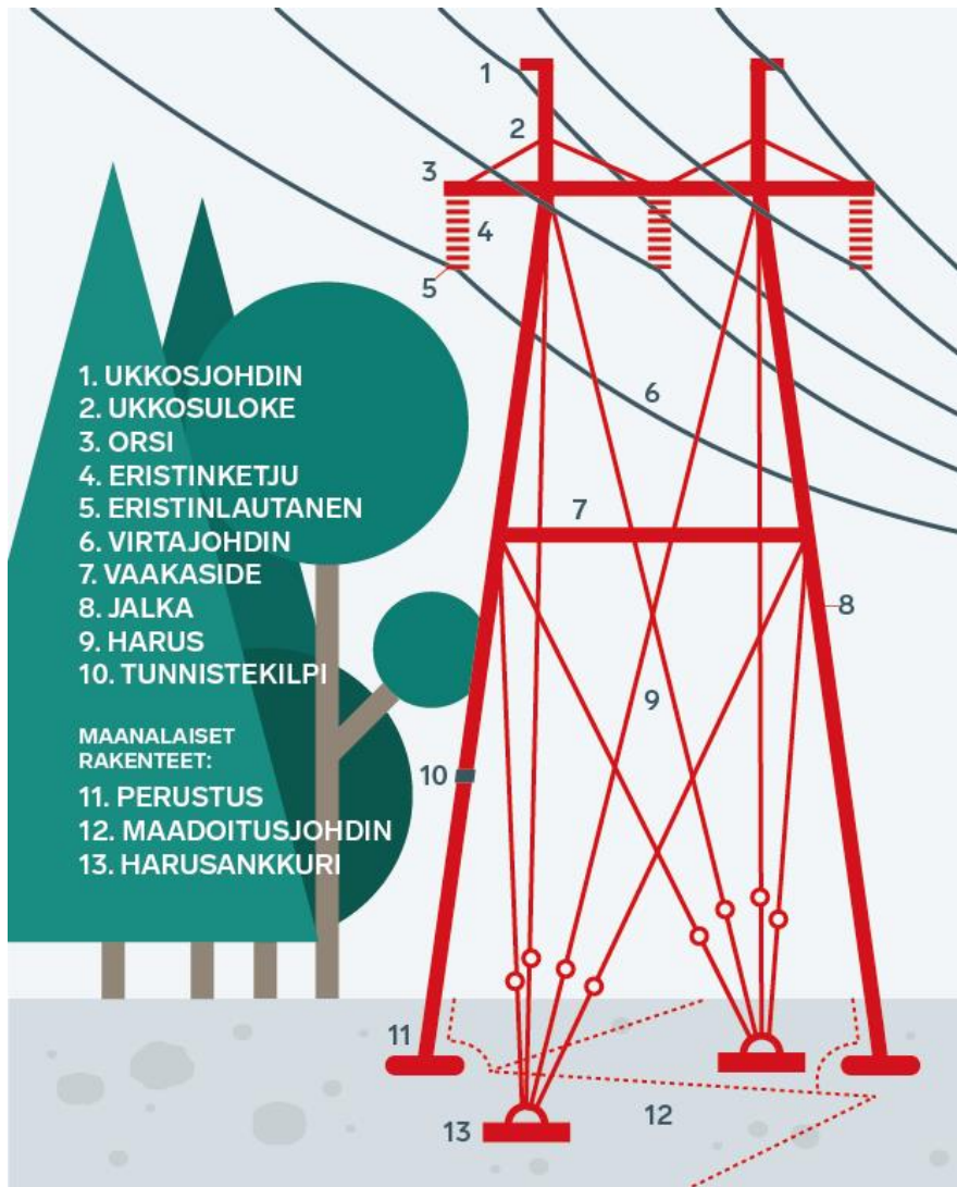
Kuva 4-7. Voimajohdon osat (Fingrid 2020a).
