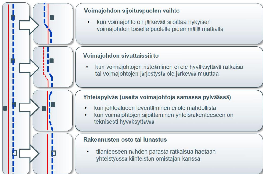
Kuva 6. Periaatteellisia esimerkkejä tavanomaisesta poikkeavista ratkaisuista haasteellisissa suunnittelutilanteissa. Käytettävissä olevat vaihtoehdot ovat aina tapauskohtaisia.
