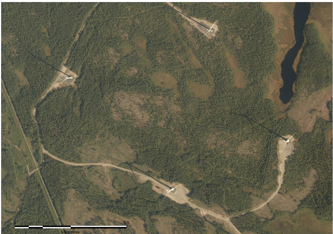
Kuva 3-4. Esimerkkikuva toiminnassa olevasta tuulivoimapuistosta. Ilmakuvassa näkyy tuulivoimaloita, huoltoteitä ja nostokentät. (MML, Ortoilmakuva)
