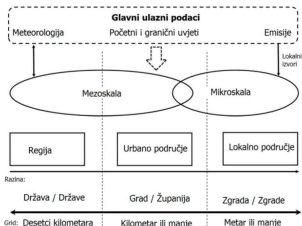
Slika 57. Generalna struktura pristupa u modeliranju zraka u ovisnosti o mjerilu (Modificirano i pojednostavljeno, prema Silveira i sur, 2019.).
