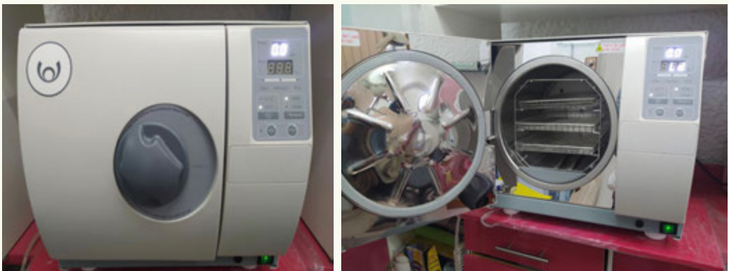
IMAGEN 10. Autoclave Tanda color. Cuenta con un panel de lectura frontal, que identifica temperatura, presión, tiempo de secado, sistema abierto y cerrado y fin de ciclo. Fuente propia.
