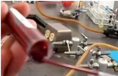
Figura C llenado del capilar
