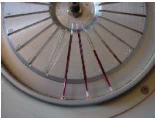
Figura D colocación de los capilares en la centrifuga
