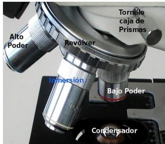
Figura 7.- Parte óptica de un microscopio. Lente Bajo Poder: Generalmente 4X Lente Mediano Poder: Generalmente 10X Lente Alto Poder: Generalmente 40X
