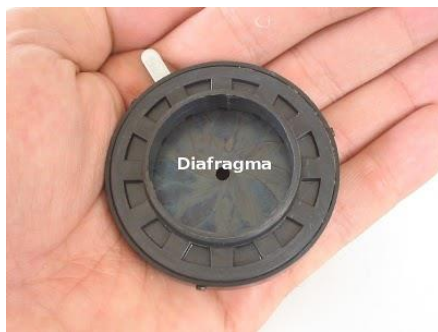
Figura 12.- Parte inferior del condensador: abertura regulable, o diafragma controlado por una palanca lateral. Controla el abrir y cerrar del diafragma.
