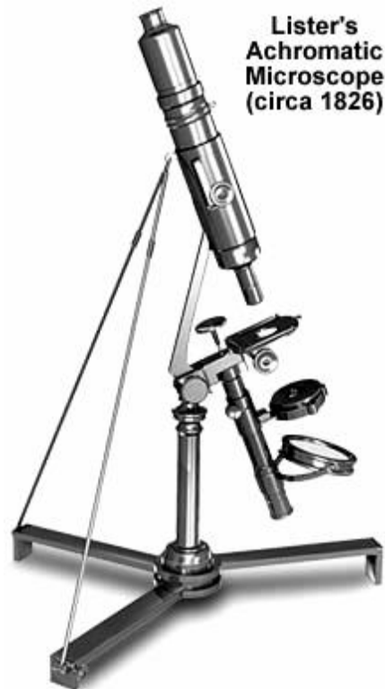
Figura 4.- Microscopio acromático diseñado y utilizado por Lister.
