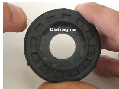
Figura 12.- Parte inferior del condensador: abertura regulable, o diafragma controlado por una palanca lateral. Controla el abrir y cerrar del diafragma.
