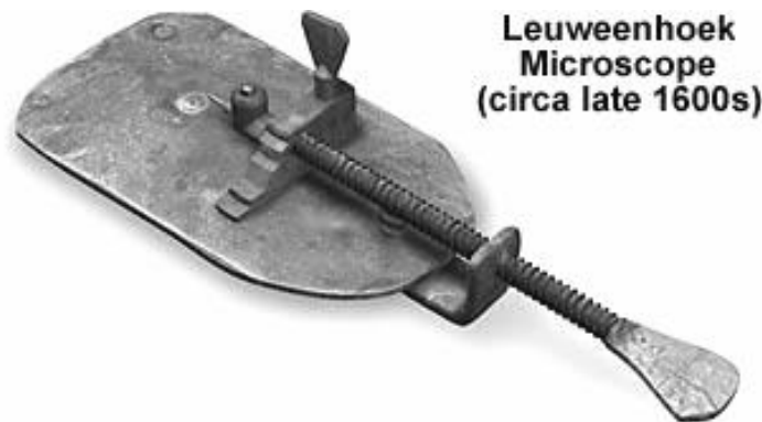
Figura 3.- Microscopio diseñado por Leeuwenhoek.
