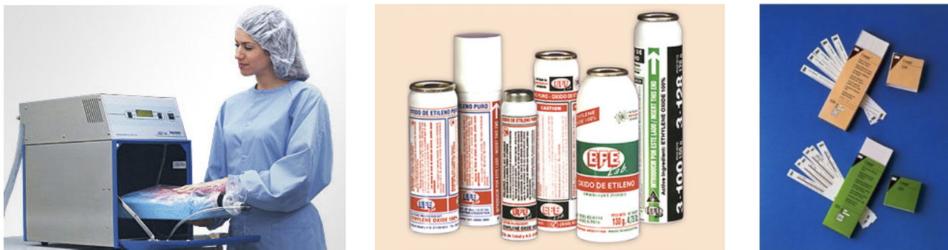
FIGURA 10. Equipo para esterilización, cartuchos y tiras de óxido de etileno. (Fuente: medicalexpo.de; efelab.com; talexco.com).
