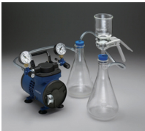
FIGURA 3. Filtración a presión reducida. (Fuente: merckmillipore.com).
