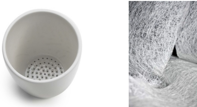
FIGURA 5. Mecanismo de atrapamiento con fibra de vidrio en crisol Goosh. (Fuente: equiposdelaboratorioimlab.com; yoli-mar.com).
