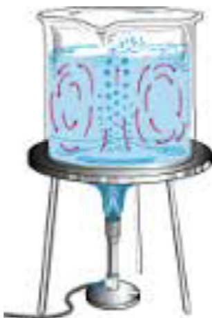
FIGURA 5. Transferencia de calor por convección.
