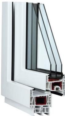
Wir bieten Ihnen **weiße Marken-Kunststofffenster** an. Diese Fenster zeichnen sich durch ein **Fünfkammerprofil** mit auswechselbarer Doppeldichtung aus. **Die Isolierverglasung, 3-fach-Verglasung** hat einen Ug-Wert von **0,60 W/m<sup>2</sup>K**.
