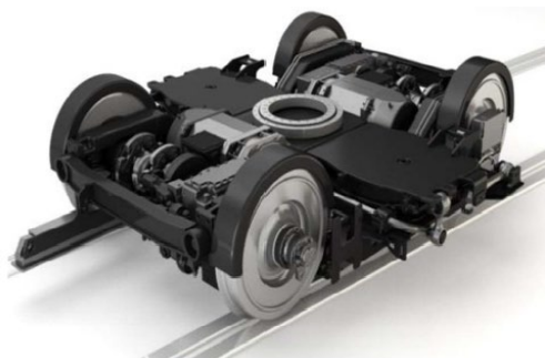
1. ÁBRA: Hagyományos, kocsiszekrény alatt elforduló forgóváz [1]
