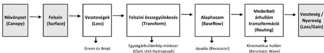
3. ÁBRA: A HEC-HMS számítási lépés moduljai
