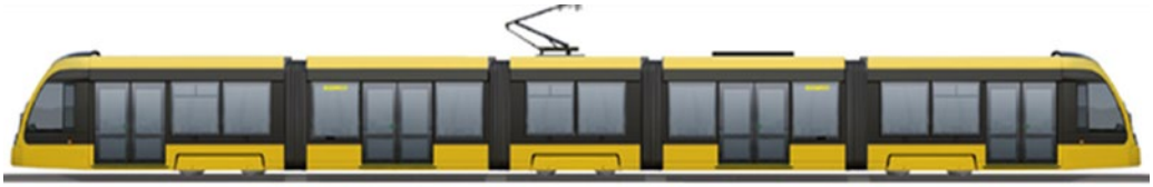
4. ÁBRA: CAF Urbos3 (5 modulós) jármű jellegrajza
