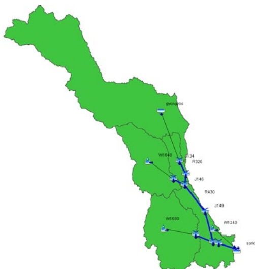
2. ÁBRA: A végleges vízgyűjtőmodell szerkezete
