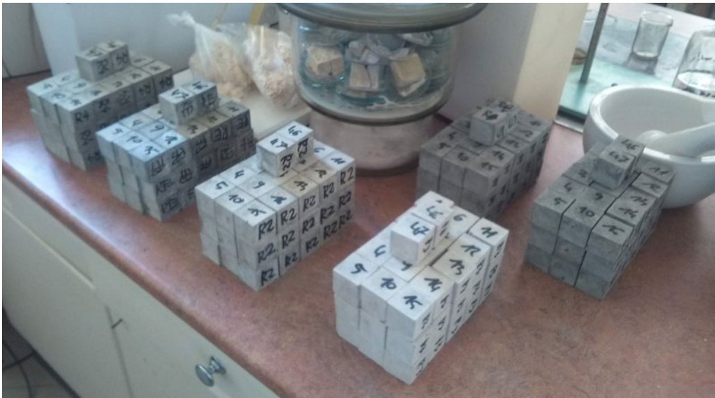
3. KÉP: A savkorróziós vizsgálatokhoz előállított cementpép próbatestek
