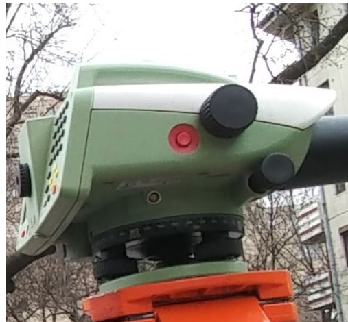
9. ÁBRA: DNA03 digitális szintezőműszer
