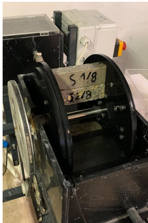
5. KÉP: A dinamikus savkorróziós esetet vizsgáló gép
