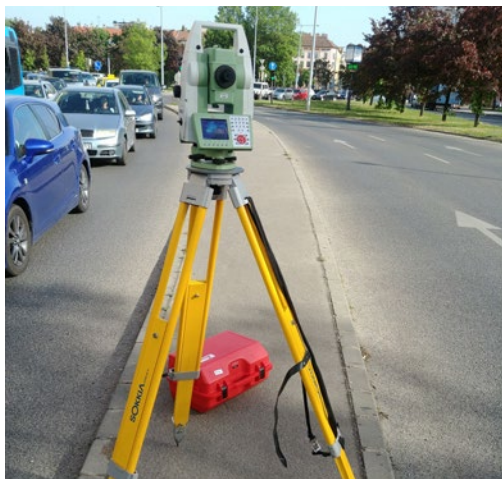
11. ÁBRA: Leica TS15i mérőállomás
