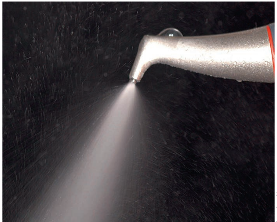
Abbildung 1: Pulverstrahlkegel bei normaler klinischer Anwendung. Im Gegenlicht sind Streubreite des Kegels und die Tropfen- beziehungsweise die Aerosolbildung gut zu erkennen.
