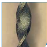
Titelbild: Mittels Funkenschlag gehärtete Oberfläche der HyFlex EDM™ Feile von COLTENE; aufgenommen unter dem Mikroskop (© COLTENE).
