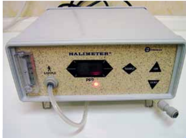
Abb. 2: Das Messgerät Halimeter. Es misst die Schwefelwasserstoffkonzentration im Atem des Patienten.
