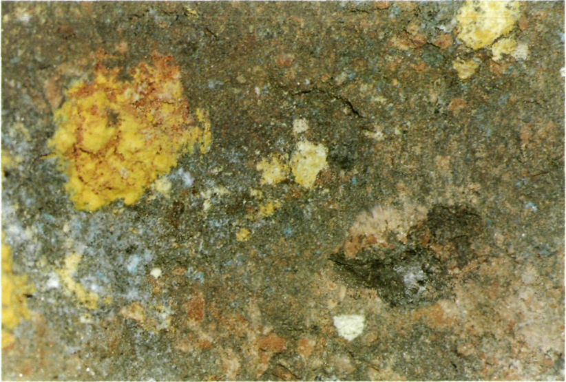
Abb. 2: Profildarstellung vom verwitternden Abraummateriale im Kiesbergbau Lading: Der graue Pyrit-Gras umschließt Aggregate von gelbem Hydronium-Jarosit, blauem Siderotil und rosarotem Römerit. Aufnahme: M. PUTTNER
