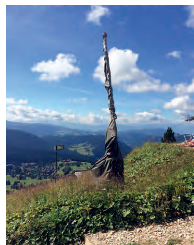
Sichtschutzplanen für stationäre Schneerzeuger (Bild: K. Jordan).
