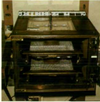
Abb. 2: Neuer Brutkasten mit zwei ausziehbaren NESTAUFLAGEN. Hinten über dem Deckel die Schalt- und Anzeigetafel. Am Deckel der Einlaß der Futterleitung und vorne die Rückwand aus Plexiglas.
