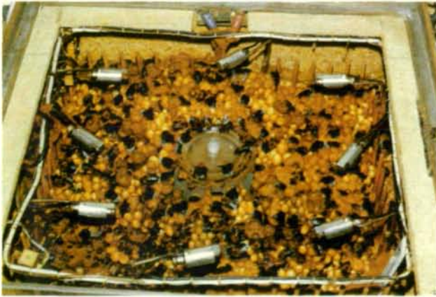
Abb. 4: Brutkasten mit Futternapf in der Mitte am Gitterboden. Der darübergesetzte Belüftungsdom mit Halterung für Futtertrichter und Futterelektroden wurde für die Aufnahme abgenommen. Unter dem Plexiglasdeckel befinden sich die 8 Heizlampen.
