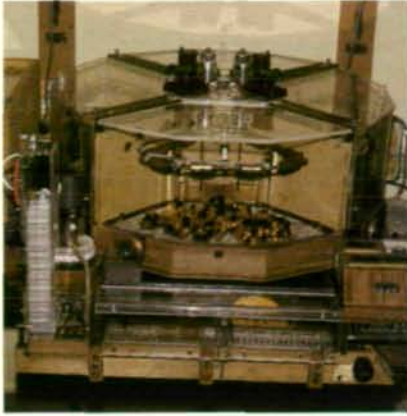
Abb. 1: Drehstock. Die rotierende Trommel nimmt vier Nester auf. Vorne unten Futterraum mit Futterstraße, links davon Nöpfchenlift. Am rechten Ende unter der Zählerlektronik befindet sich der Nöpfchenauswurf.
