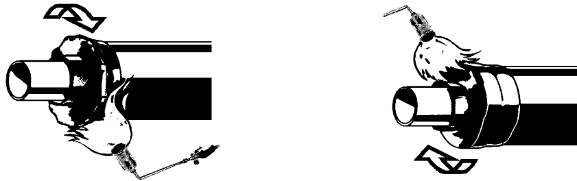
Aufschrumpfen der Manschette auf Seite des Leitungsrohrs
