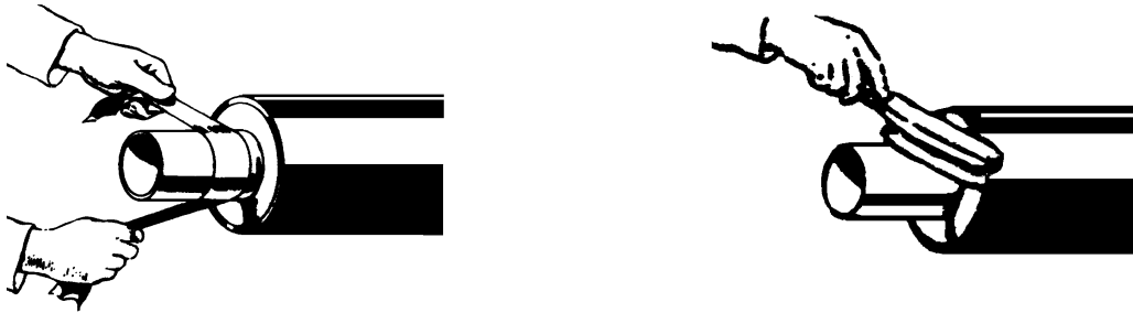
Vorbereitung der Medien- und Mantelrohroberfläche vor dem Anlegen der Thermoschrumpfmanschette
