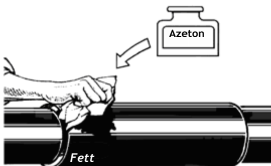
Entfetten der Rohrverbindungsstellen
