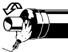
Aufschrumpfen der Manschette auf Seite des Leitungsrohrs
