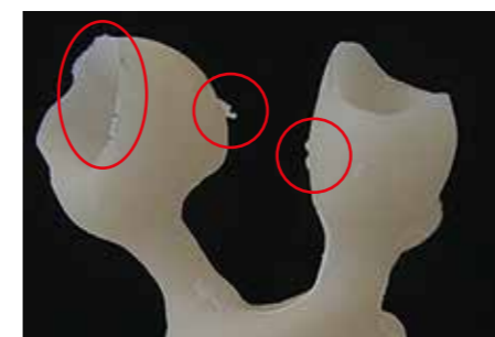
Bild 1 - Pressfahnen am Rand durch Rissbildung in der Muffel
