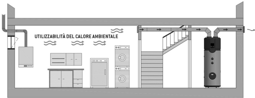
Warmwasserwärmepumpe mit Luftleitungen (Zufuhr-Luft - Abgabe-Luft)
