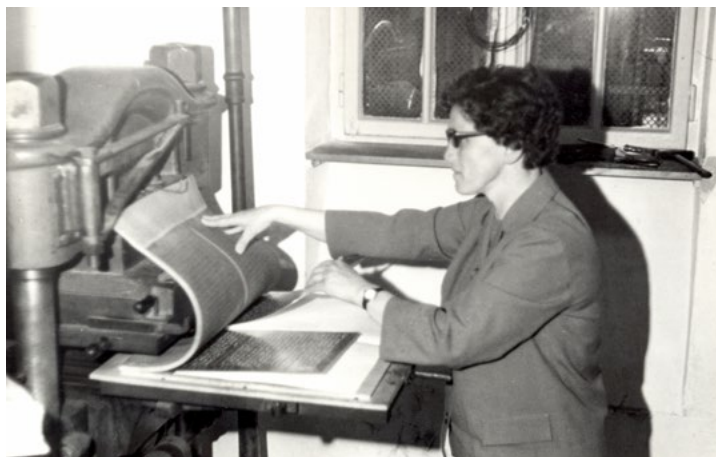
Ročno izdelovanje matric za tiskanje učbenikov v brajici (k poglavju o informativni dejavnosti ZDSSS).
