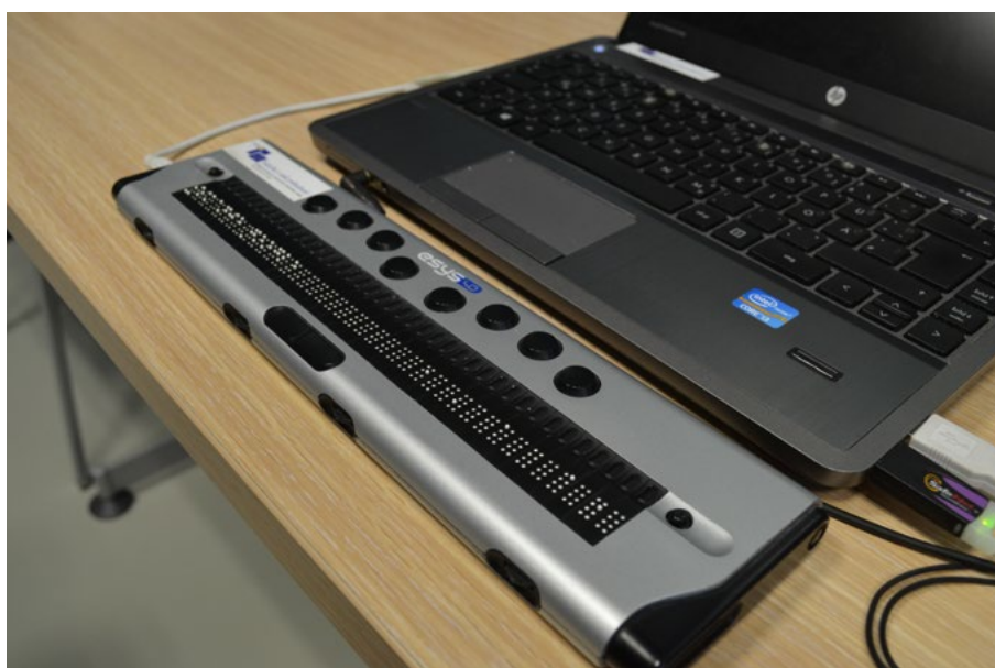
Slepim delo z računalnikom olajša brajeva vrstica (Foto: arhiv ZDSSS).
