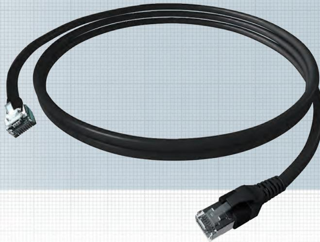
Câble de raccordement RJ45/RJ45 blindé avec brochage 1:1. Une prise saCon avec surmoulage dual-boot est utilisé d'un côté. De l'autre côté, un connecteur RJ45 hautement compact est utilisé. Ce câble a été développé spécialement pour l'application VoIP étant donné qu'un espace très réduit est disponible pour la prise sur les téléphones VoIP. Le câble utilisé offre une sécurité maximale des données via son blindage combiné (PiMf + tresse), ainsi que grâce à ses prises RJ45 blindées à 360°.
