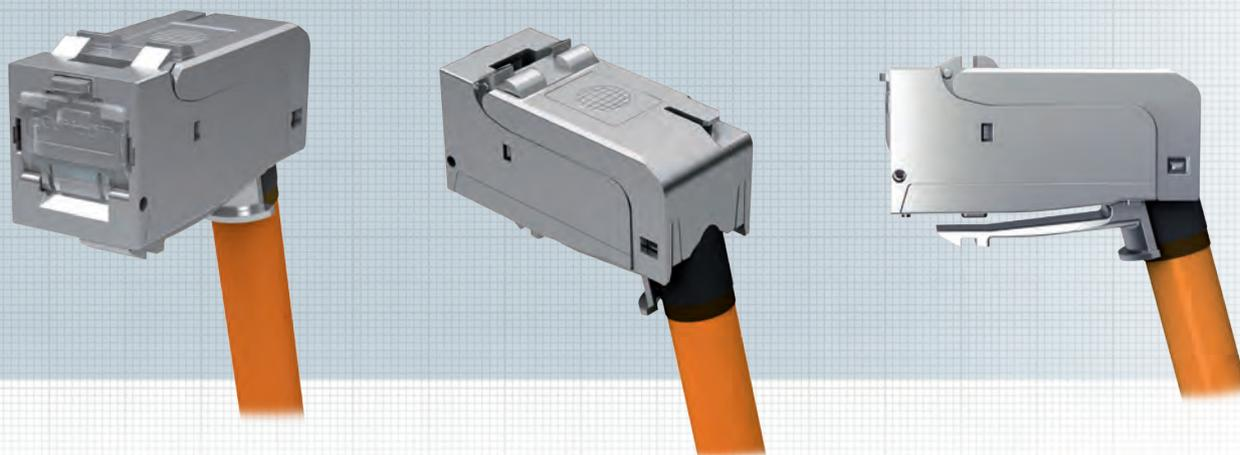
Le module fixLink® SL RJ45 Keystone est développé spécialement pour les applications avec des contraintes d'espace. La sortie du câble à 75° rend le module particulièrement adapté pour une utilisation dans les plastrons et les installations de câbles dans les cavités. La profondeur d'installation minimale de 27 mm permet une variété d'applications quasiment illimitée. Le module fixLink® SL RJ45 Keystone peut être assemblé en moins d'une minute en utilisant une pince coupante.
