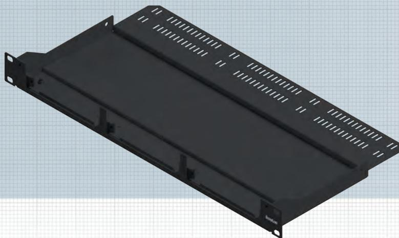
Support de module (CR) pour une utilisation avec 7 modules d'insertion HP en cuivre et FO. Les modules d'insertion sont fixés sur le support de module du côté du panneau à l'aide de 2 vis. Les modules d'insertion peuvent être entièrement extraits du support de module. Un maximum de 3 x modules d'insertion 7HP (18 ports) peut être monté dans le support de module.
