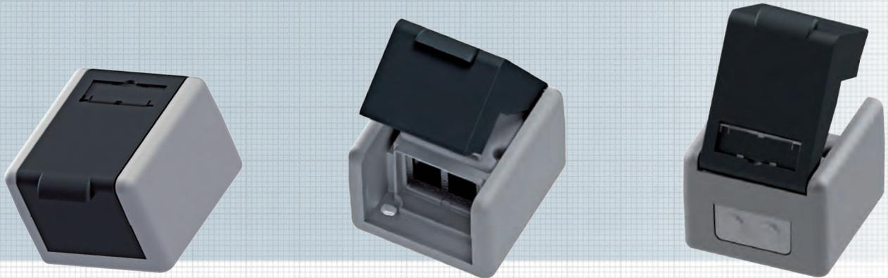
Le boîtier IP44 convient pour l'installation des modules Keystone preLink® et fixLink®. Pour les presse-étoupes de câbles avec un diamètre de 7,0 à 9,5mm, il existe deux positions qui sont facilement pénétrables. Une fois branché, le réceptacle du module offre une catégorie de protection IP20, lorsqu'il est fermé, il offre une catégorie de protection IP44.
