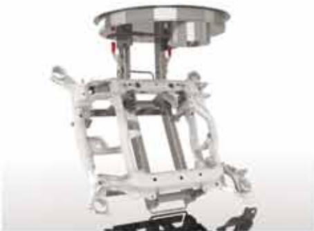
Motorträgerkonsole, beschichtet mit einem Zink-Lamellensystem
