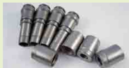
Mit ZnNi / EcoTri® NC und Corrosil® Plus 301 in Trommelanwendung beschichtete Teile
