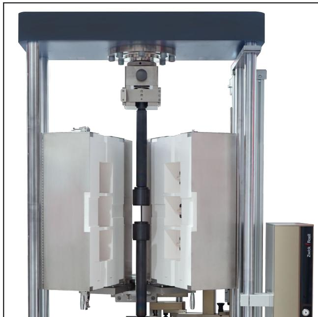
Keramik Laststrang in Zeitstandprüfmaschine Kappa SS
