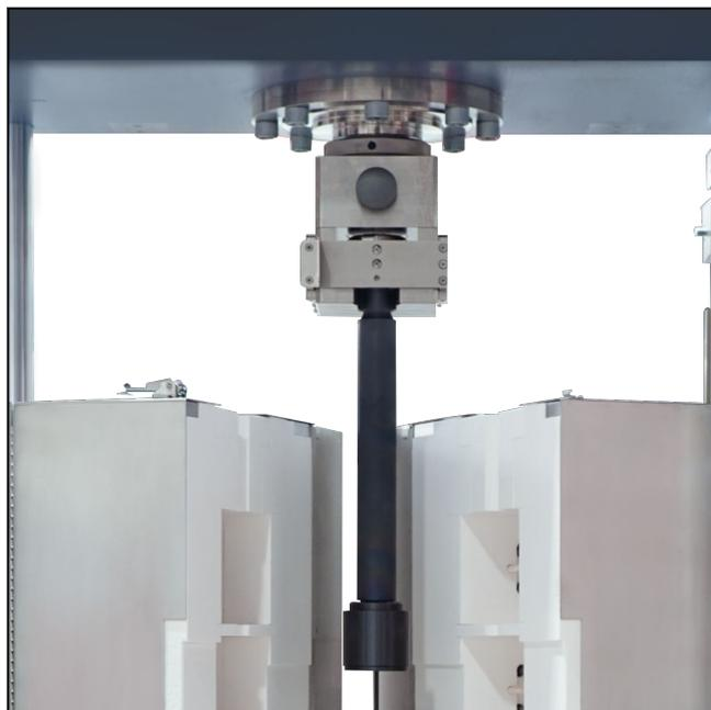
Hochtemperatur-Zuggestängeaufnahme für Zeitstandprüfmaschinen
