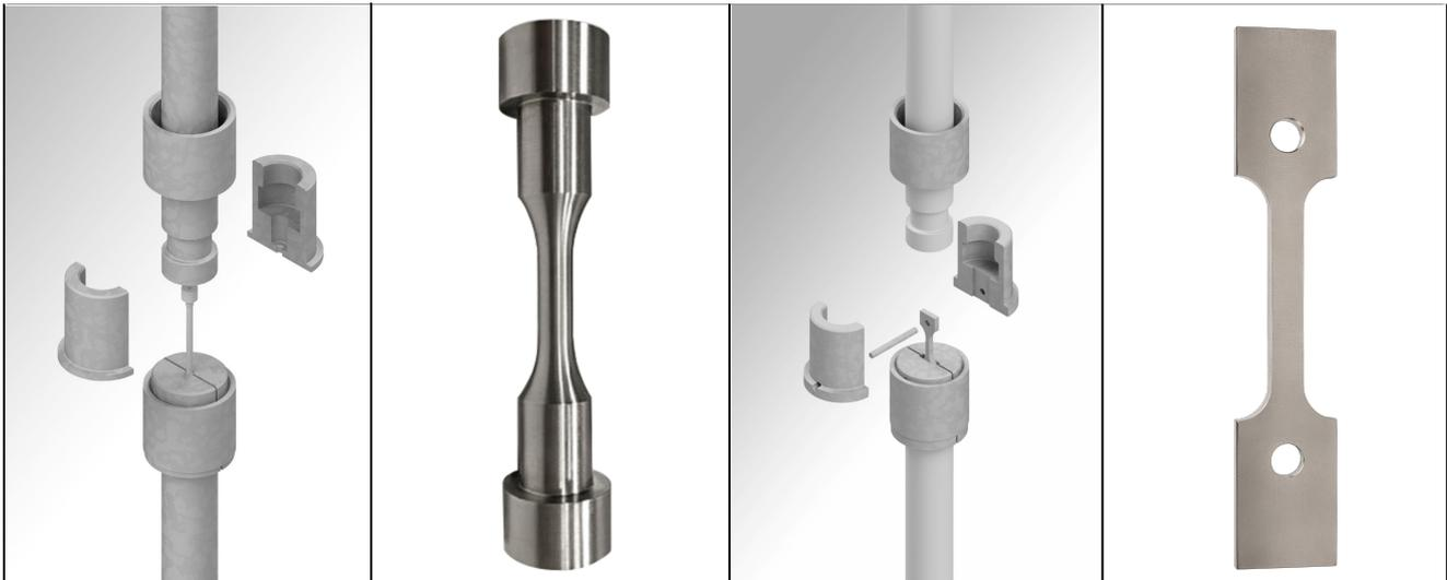
Probenadapter für Rundproben mit Schulterkopf
