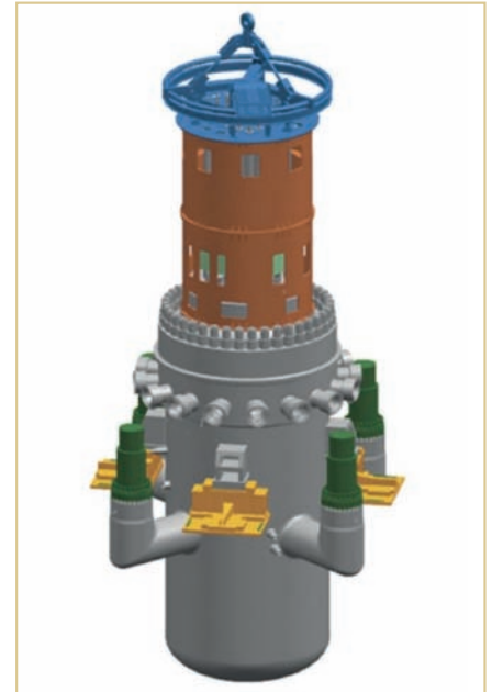
Figura 3. Detalle del reactor ACP-100
