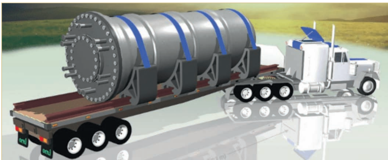
Figura 9. Representación conceptual del transporte en camión de un reactor SMR
