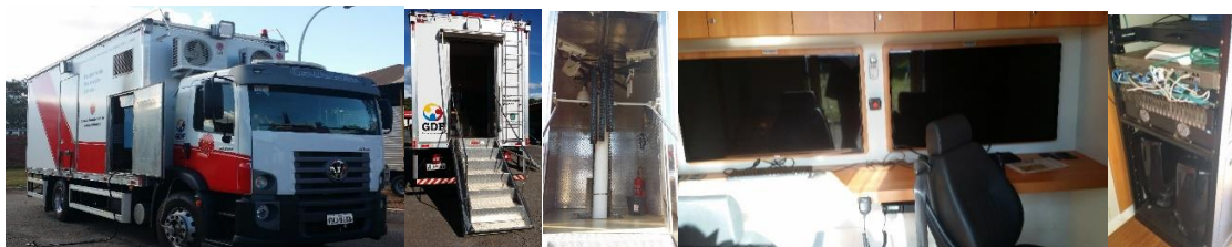
Figs. 40 a 43: Visão externa, câmeras, sala de operação, equipamentos de gravação, armazenamento e transmissão.
