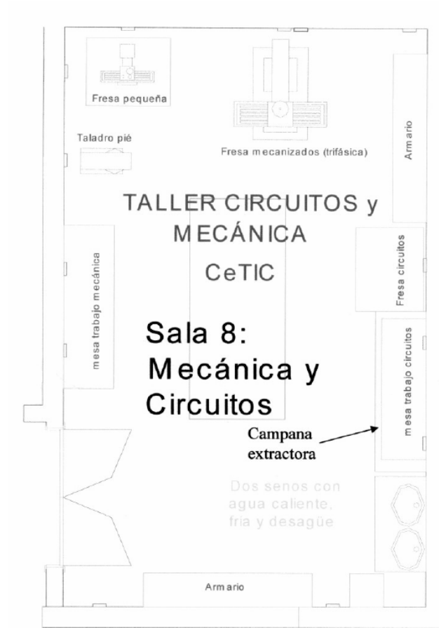
Figura 5.11: Espacio asignado en el semisótano del edificio Polivalente II del Parque Científico Tecnológico (dedicado a la sala de taller y mecánica de circuitos).
