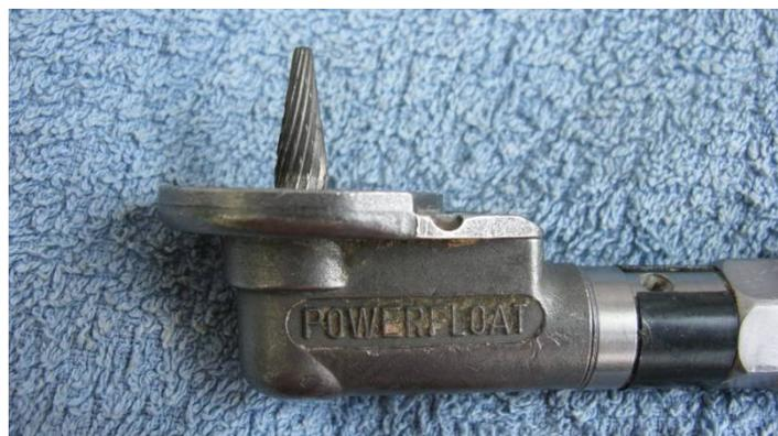
**Figure 74. Pointe montée sur un Powerfloat® électrique permettant l'élargissement des diastèmes (P.C.)**
