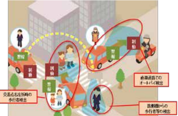
79GHz自動車レーダー(免許不要局:平成29年1月制度化) 検知物の高分解能の実現のために周波数を拡大
