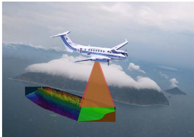
図5：低潮線調査の例（航空レーザー測量）（海上保安庁資料）
